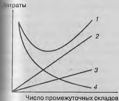
Рис. 6.2. Зависимость дистрибуционных затрат от числа промежуточных складов: 1 — общие затраты; 2 — затраты на хранение; 3 — складские затраты; 4 — транспортные затраты
