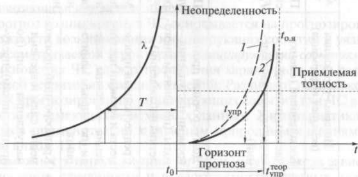
Рис. 12.2. Зависимость точности прогноза повторяемости от интервала наблюдения T (слева) и момента наступления опасного явления от времени упреждения t_{\text{упр}} (справа): хуже (1) и лучше (2) изученный механизм формирования опасного явления; t_0 — текущий момент времени (пояснение в тексте)
