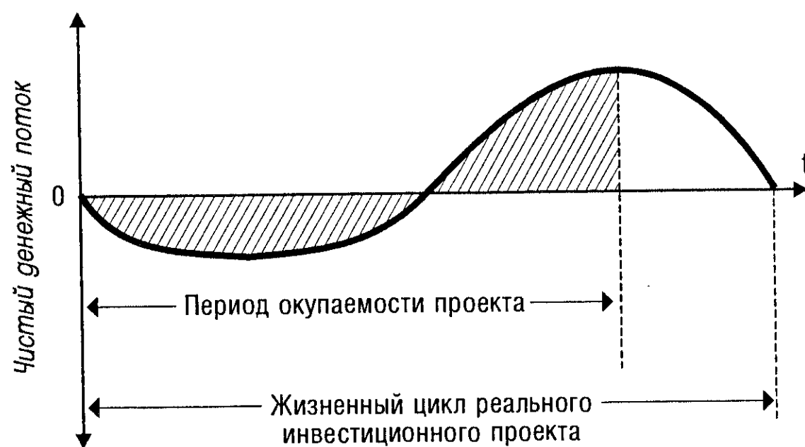
Рисунок 10.13. График формирования чистого денежного потока по реальному инвестиционному проекту в течение его полного жизненного цикла
