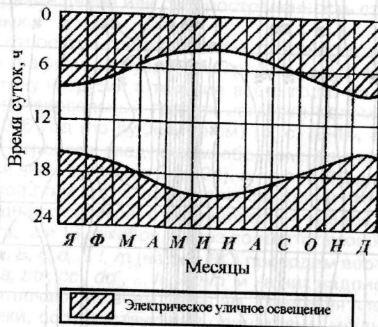
Рис. 7.8. Универсальный график работы электрического уличного освещения
