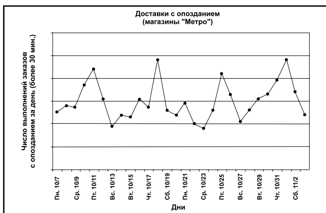
Рисунок 6.9. Данный график серий (трендов) показывает число выполнений заказов с опозданием для компании «Шестисигмовая пицца» по дням. Наблюдается некоторая периодичность (пики опозданий по пятницам), однако команде DMAIC следует изучить данные более тщательно.
