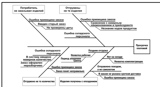
Рисунок 6.4. Диаграмма причин и результатов, или диаграмма «рыбий скелет». Для каждой ситуации определяются свои категории причин (часто называемые «главными костями» рыбы).
