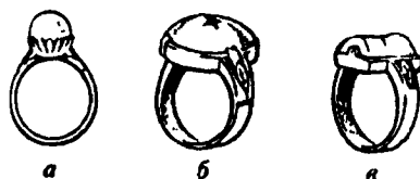
Рис. 6. Кольца с креплением ювелирного камня штифтом: a —жемчуг установлен на тарелочку; b —коралл на тарелочке; v —бирюза упирается в подпятник
