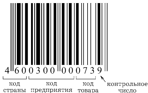
Рис. 62. Код EAN-13. Внешний вид и структура. В основном применяется для кодирования товаров народного потребления
