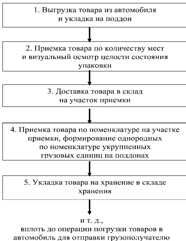
Рис. 114. Транспортно-технологическая (структурная) схема переработки груза на складе предприятия оптовой торговли
