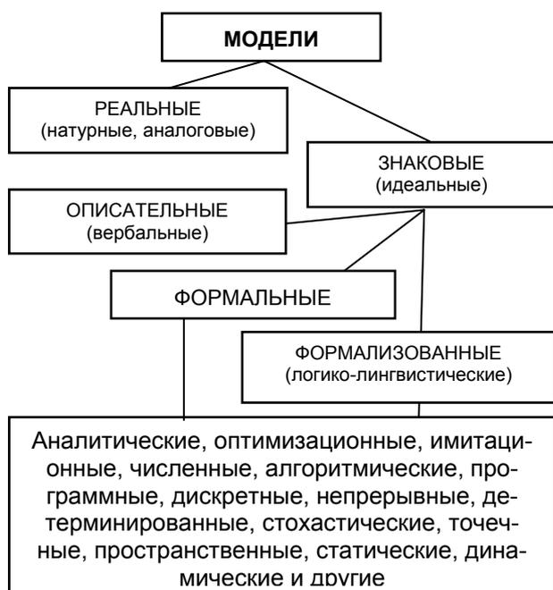
Рис. 1.2. Классификация моделей (вариант)
