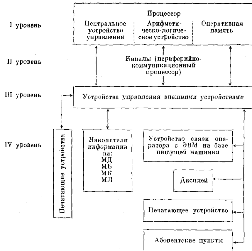
Рис. 3. Структурная схема ЕС-ЭВМ.
