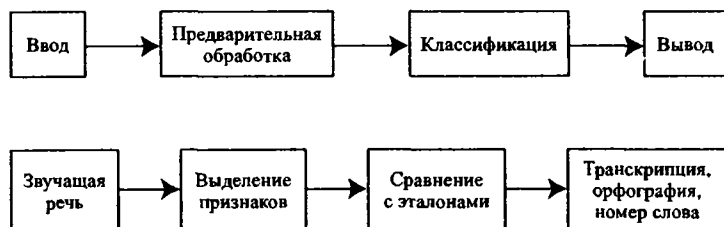
Рис. 3. Структурная схема устройства распознавания изолированно произнесенного слова
