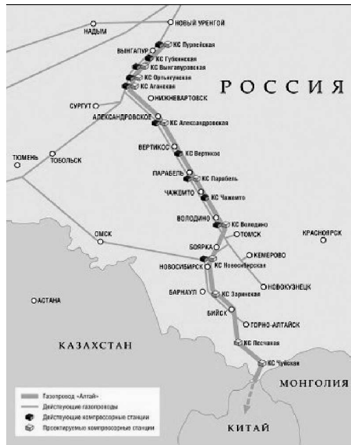
Рис. 15.6.14. Схема проекта газопровода «Алтай»
