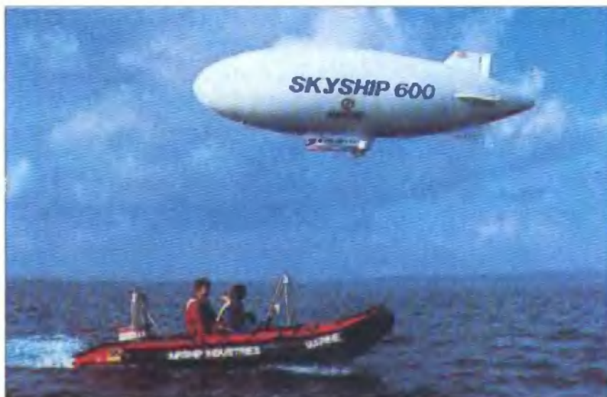
Рис. X. Катер, опущенный на воду с борта зависшего над водой дирижабля Skyship-600
