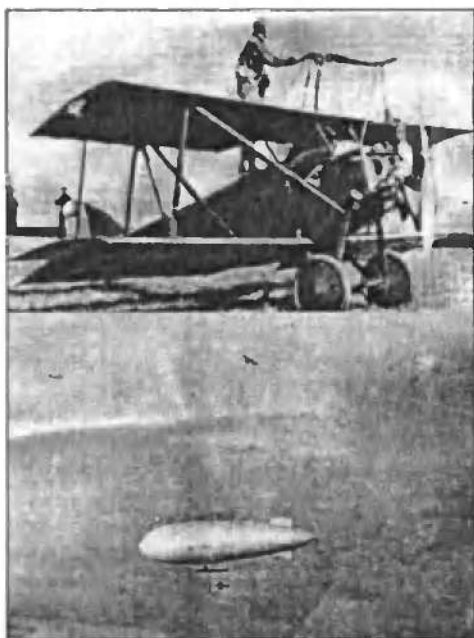
Рис. 284. Дирижабль TC-3 с причаленным к нему самолётом Sperry "Messenger", оборудованным специальным крюком (вверху)
