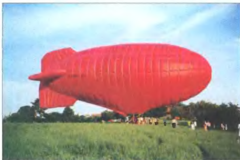
Рис. VIII. Тепловой дирижабль AV-1R
