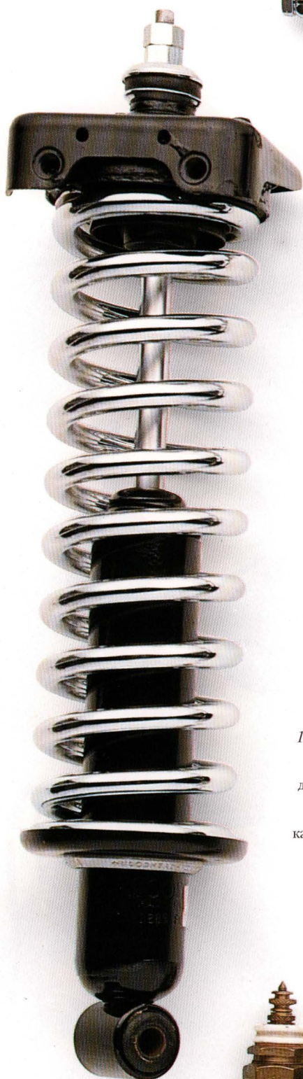
Телескопический амортизатор и пружина
