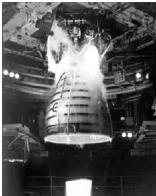
Испытания ракетного двигателя шаттла – многоразового космического корабля
