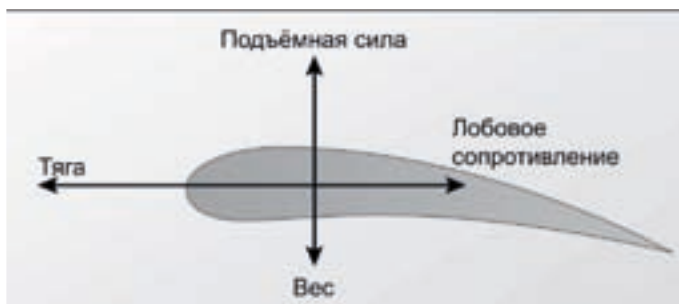
Силы, действующие на самолёт
