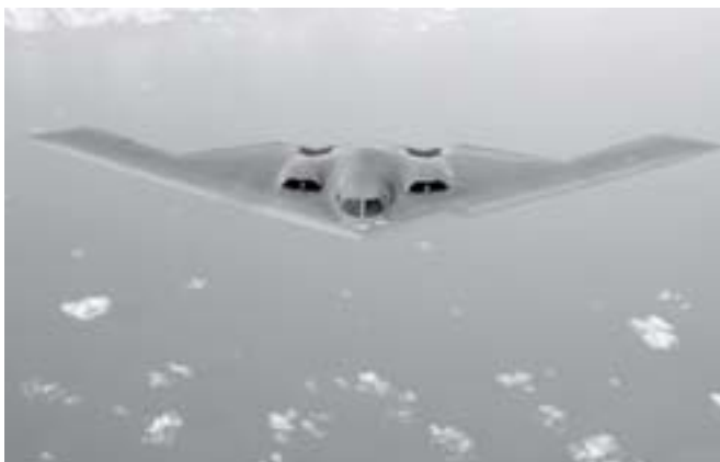
Американский стратегический бомбардировщик B-2 «Спирит» создан в виде «летающего крыла»: он целиком обладает аэродинамической поверхностью
