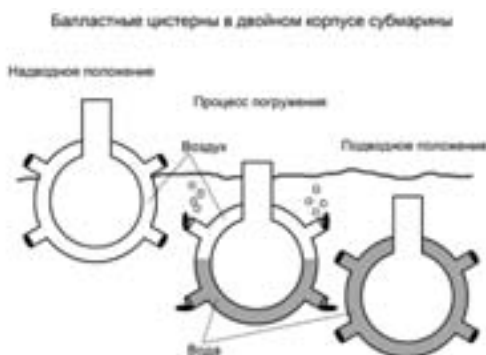
Балластные цистерны в двойном корпусе субмарины
