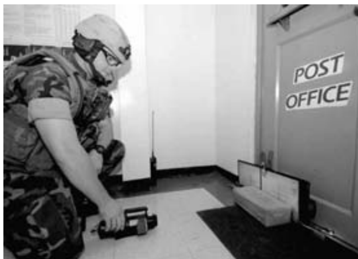
Военнослужащий с помощью портативной рентгеновской установкой просвечивает подозрительную посылку, чтобы выяснить, не бомба ли это
