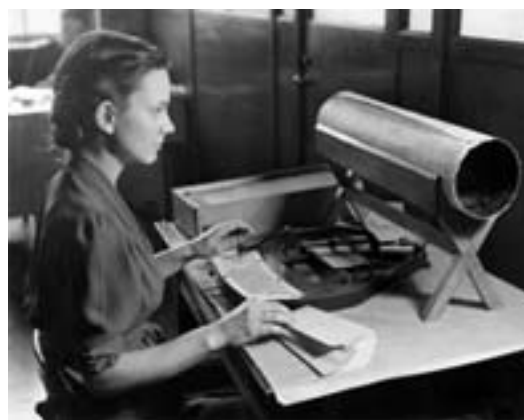
Женщина заносит данные переписи населения на перфокарты, используя простейший перфоратор (1940)
