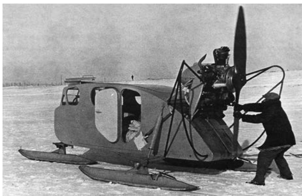
Запуск от руки винта аэросаней НКЛ-16, 1937
