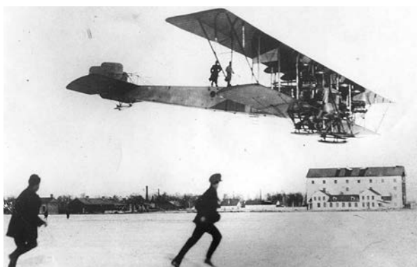
Самолет «Илья Муромец», хорошо видна прогулочная палуба на фюзеляже
