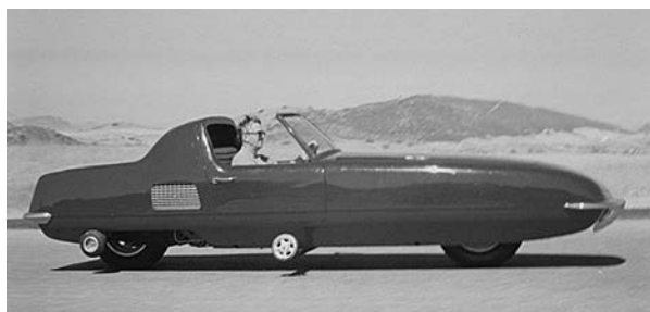
Гуро-Х, 1967. Гирокар, построенный Луисом Суинни и Алексом Тремулисом. Единственный исторический автомобиль такого типа, сохранившийся до наших дней (ныне на реставрации).
