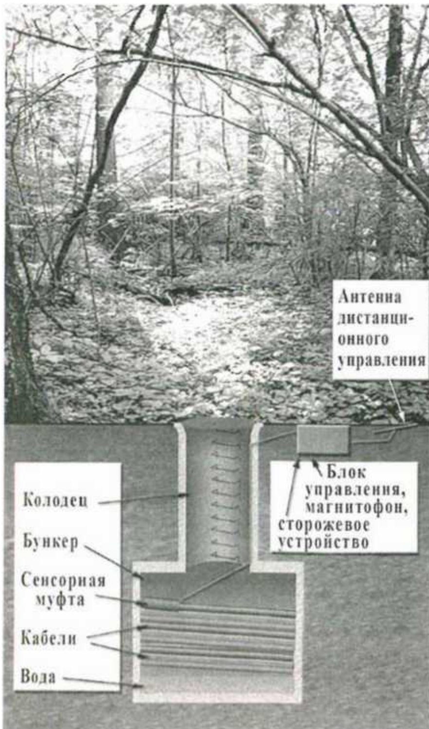
Операция ЦРУ СКАТ. Схема установки спецтехники в колодце на Калужском шоссе в Подмоскowie.
