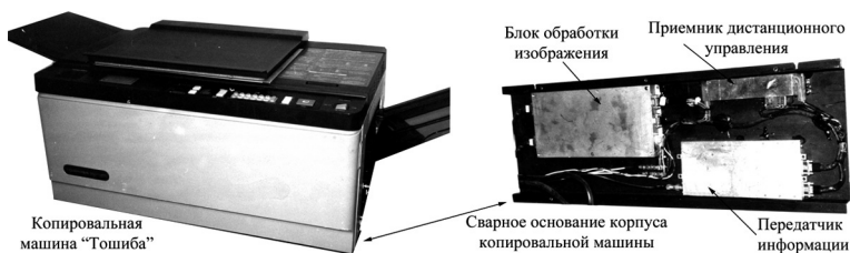
Аппаратура ЦРУ внутри копировальной машины (из архива Keith Melton Spy Museum)
