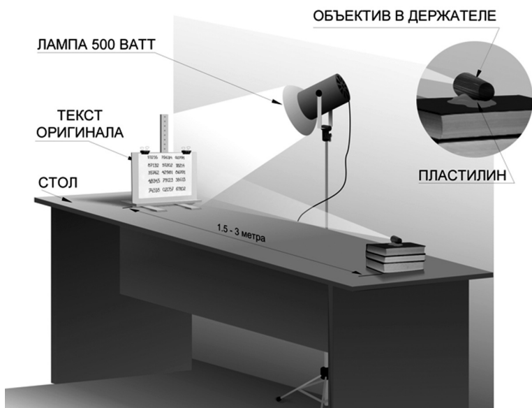
“Прямое” фотографирование микроточки с помощью специального объектива (из архива Keith Melton Spy Museum)
