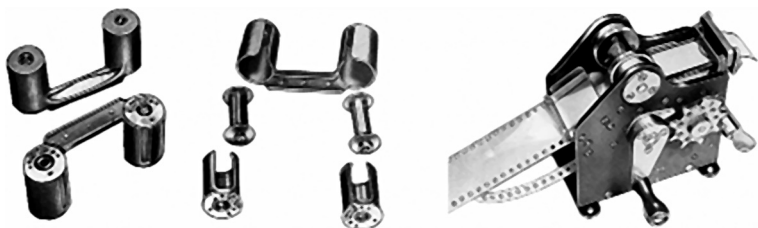
Кассеты для «Аякса-12» и резака для удаления перфорации и подготовки отрезка пленки длиной 600 мм (из архива Keith Melton Spy Museum)
