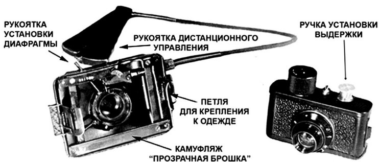
Фотокамера «Аякс-10» с объективом А-4; слева механизм камуфляжа с рукояткой дистанционного управления (из архива Keith Melton Spy Museum)
