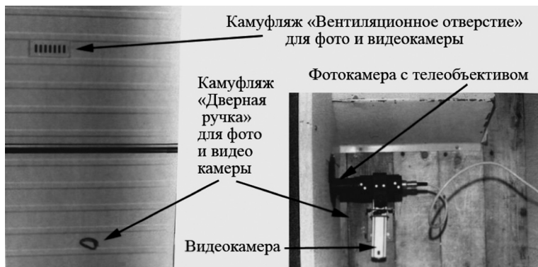
Элементы наблюдательного поста ШТАЗИ в «рефрижераторе» (из архива Detlev Vreisleben Collection)
