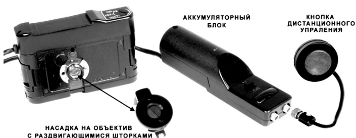
Фотоаппарат «Неоцит» (Ф-27) с пультом дистанционного управления (из архива Detlev Vreisleben Collection)
