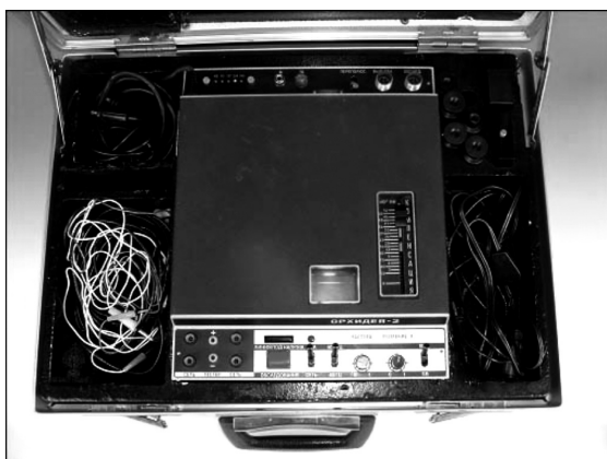
Поисковый аппарат «Орхидея-2» для обследования коммуникаций (из архива Keith Melton Spy Museum)
