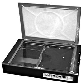
Специальный копировальный аппарат «Ян» и обычный портфель для его переноски (из архива Detlev Vreisleben Collection)
