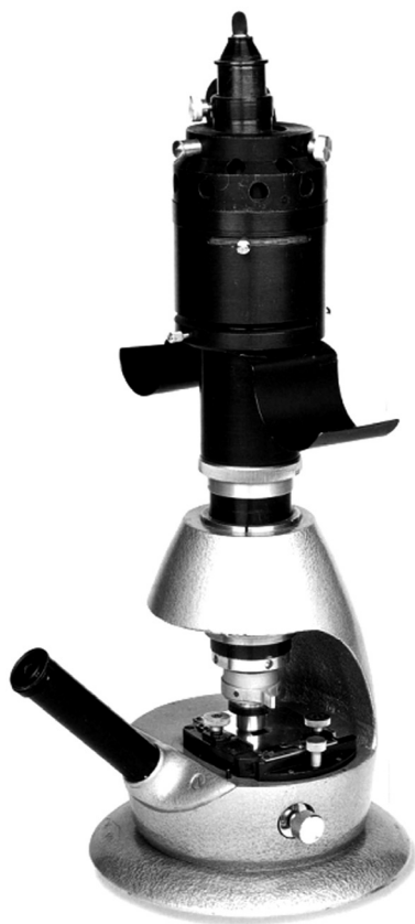
Прибор «Багульник» для фотографирования микроточек в стационарных условиях (из книги Кита Мелтона «Ultimate Spy», 2002, page 153)
