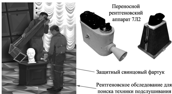
Поиск техники подслушивания с помощью рентгеновской установки (из архива Keith Melton Spy Museum)
