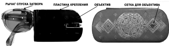
Камуфляж «чехол для очков», изготовленный в МГБ ГДР для советского фотоаппарата «Точка-58М» (из архива Keith Melton Spy Museum)
