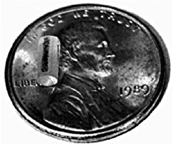
Объектив «Пуля» в сравнении с монетой в один цент США (из архива Keith Melton Spy Museum)
