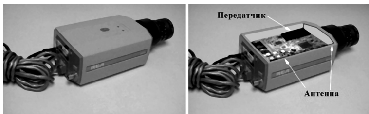
Видеокамера RCA с передатчиком и антенной (из архива Keith Melton Spy Museum)
