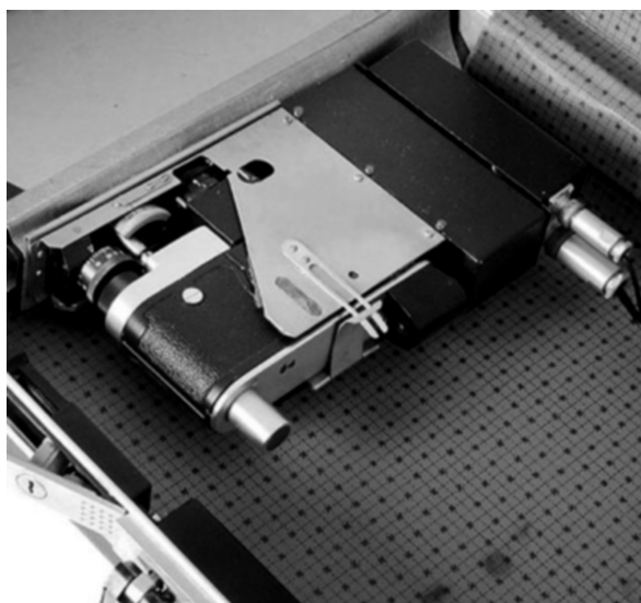
«Зола» внутри камуфляжа «Атташе-кейс» у боковой его стенки. Фотоаппарат закреплен внутри механизма управления затвором (из архива Keith Melton Spy Museum)
