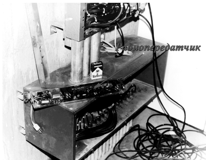
Канальный телевизионный усилитель с радиопередатчиком внутри (из архива Keith Melton Spy Museum)
