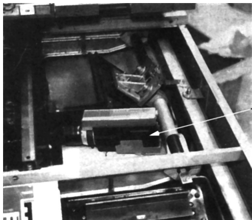
Копирующая машина «Ксерокс» с кинокамерой внутри (из архива Keith Melton Spy Museum)
