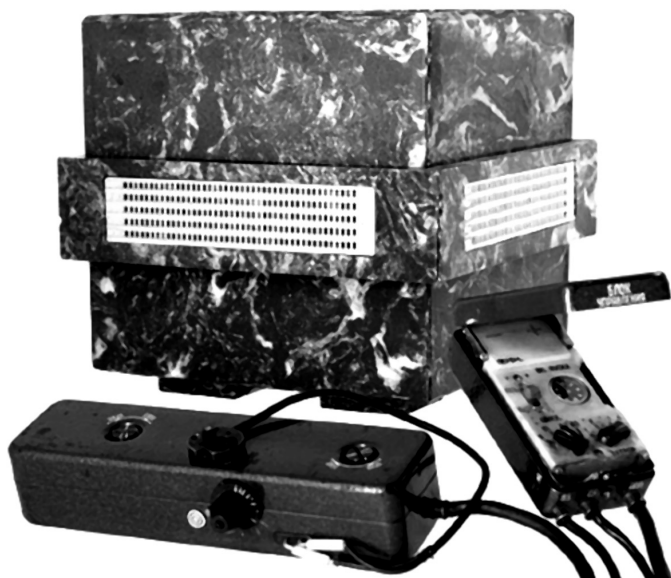
Камуфляж «Цветочная тумба» для фотоаппарата «Забег» с таймером. Фотографирование производилось через боковые декоративные решетки (из архива Keith Melton Spy Museum)
