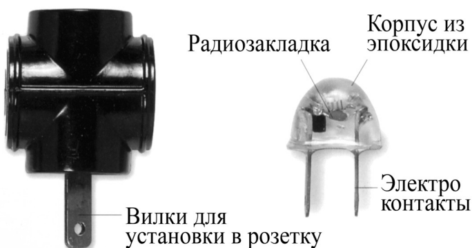
Радиозакладка в сетевом тройнике (из архива Keith Melton Spy Museum)
