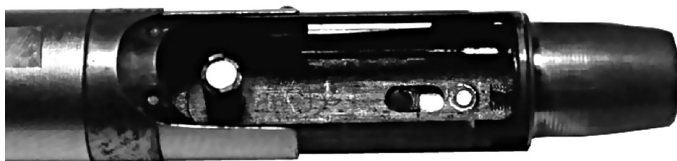
Отсек для установки кассеты с пленкой (из архива Detlev Vreisleben Collection)
