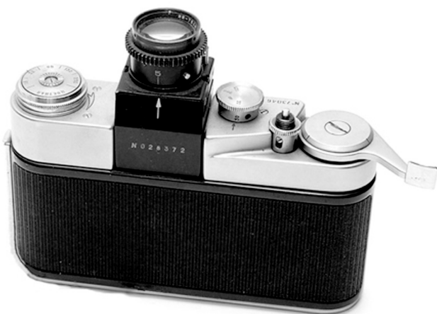
Фотоаппарат «Циния» с торцовым объективом ИК-75ЛМ и боковым взводом рабочей пружины (из архива Keith Melton Spy Museum)
