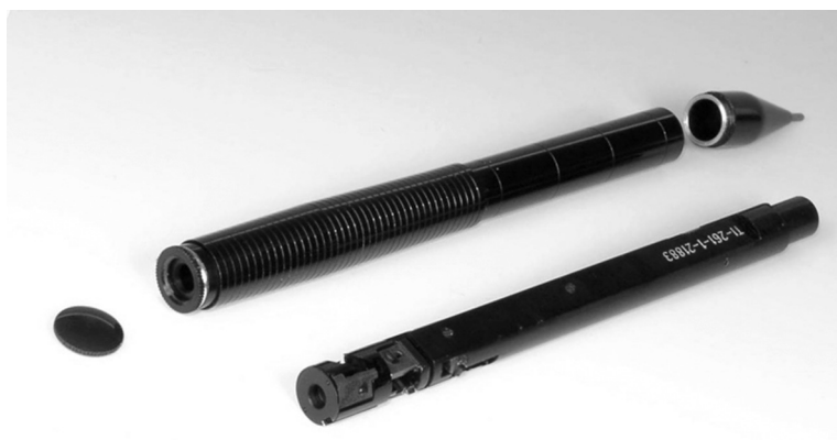
Уникальная микрофотокамера «Давид» в цанговом карандаше (из архива Detlev Vreisleben Collection)
