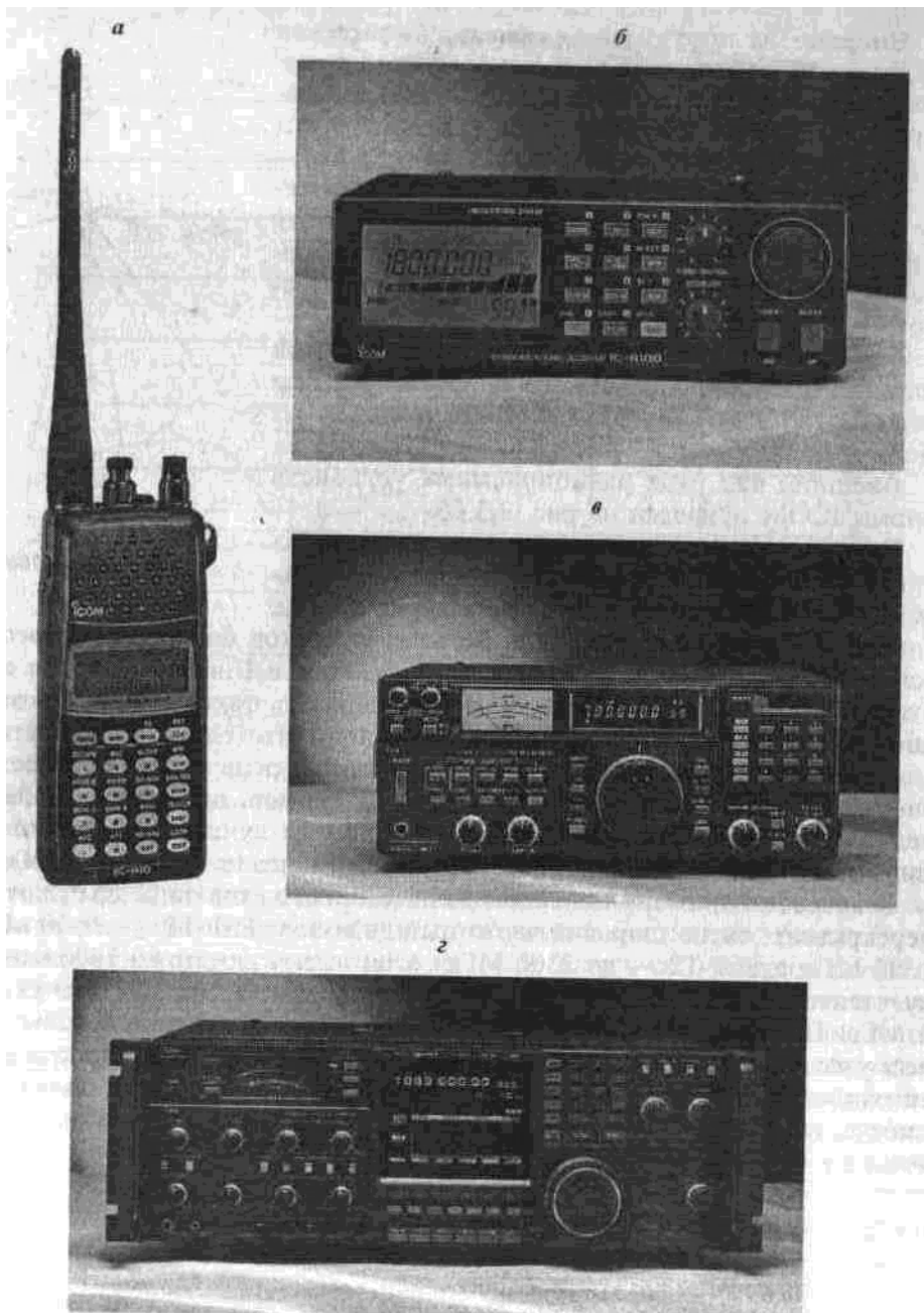
Рис. 2.3.16. Панорамные приемные устройства фирмы ICOM: а – IC-R10; б – IC-R100; в – IC-R7000; г – IC-R9000
