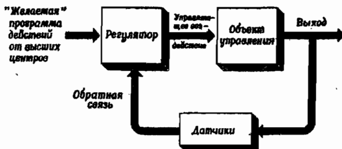
Рис. 41. Общая схема системы, использующей для вычисления управляющего воздействия обратную связь, по которой поступает информация о текущем состоянии управляемого объекта.
