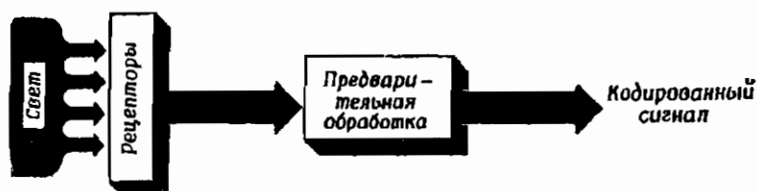
Рис. 21. Схема организации предварительной обработки зрительного образа. Рецепторы преобразуют распределение интенсивности света в градуальные изменения мембранного потенциала. Следующие за ними слои нейронов обеспечивают предварительную обработку этих потенциалов и кодируют то, что видит глаз, в форме пространственно-временной структуры спайков, поступающей в мозг.
