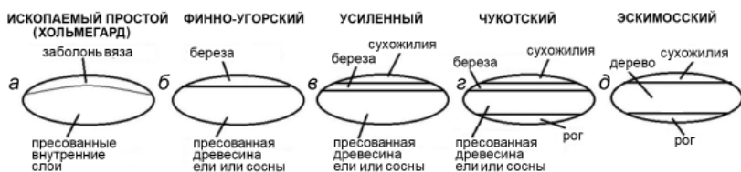
Рис. 6.17. Схема технического совершенствования лука на протяжении истории его использования. Из: Insulander, 2002
