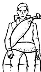
Рис. 5.35. Надувные ремни безопасности и фазы перемещения пассажира, пользующегося надувной подушкой при фронтальном столкновении
