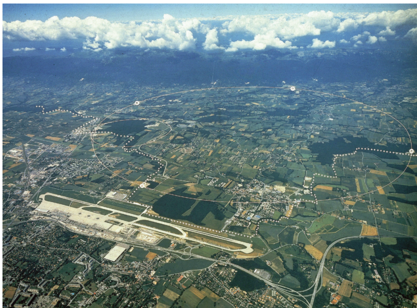
Женева. 27-километровое подземное кольцо ускорителя «Большой адронный коллайдер», проходящее по территориям Швейцарии и Франции. На переднем плане виден аэродром
