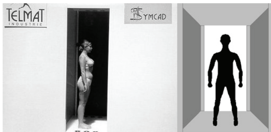
Рис. 4.3. Антропометрическое обследование фигур методом 3D-бодисканирования
