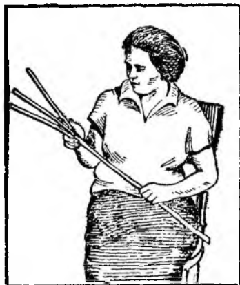
Рис. 26. Раскалывание прута вручную колунком
