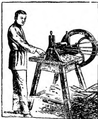
Рис. 27. Раскалывание прута механическим способом на станке «шиф»
