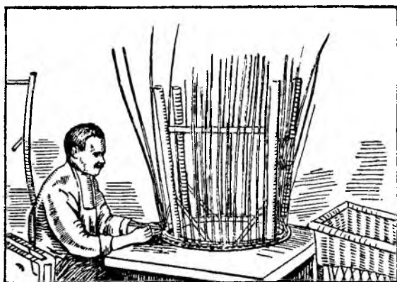
Рис. 102. Процесс изготовления подстоля для круглого стола
