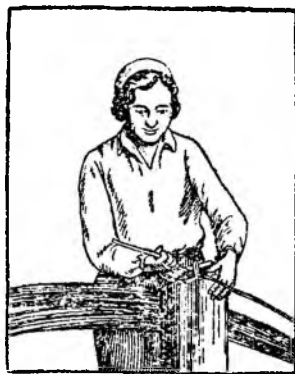
Рис. 28. Строжка лент вручную на ручном станке «шоф»
