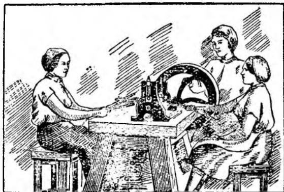
Рис. 29. Механизированная строжка лент на станке «шиф» с ручным вращением станка
