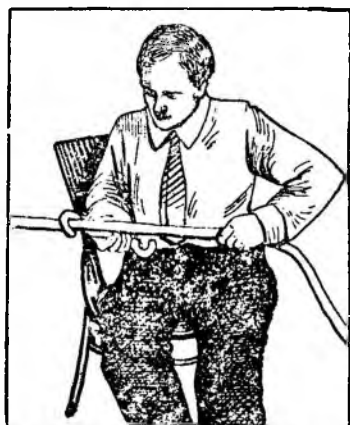
Рис. 74. Процесс выпрямления и загибания палок жамкой
