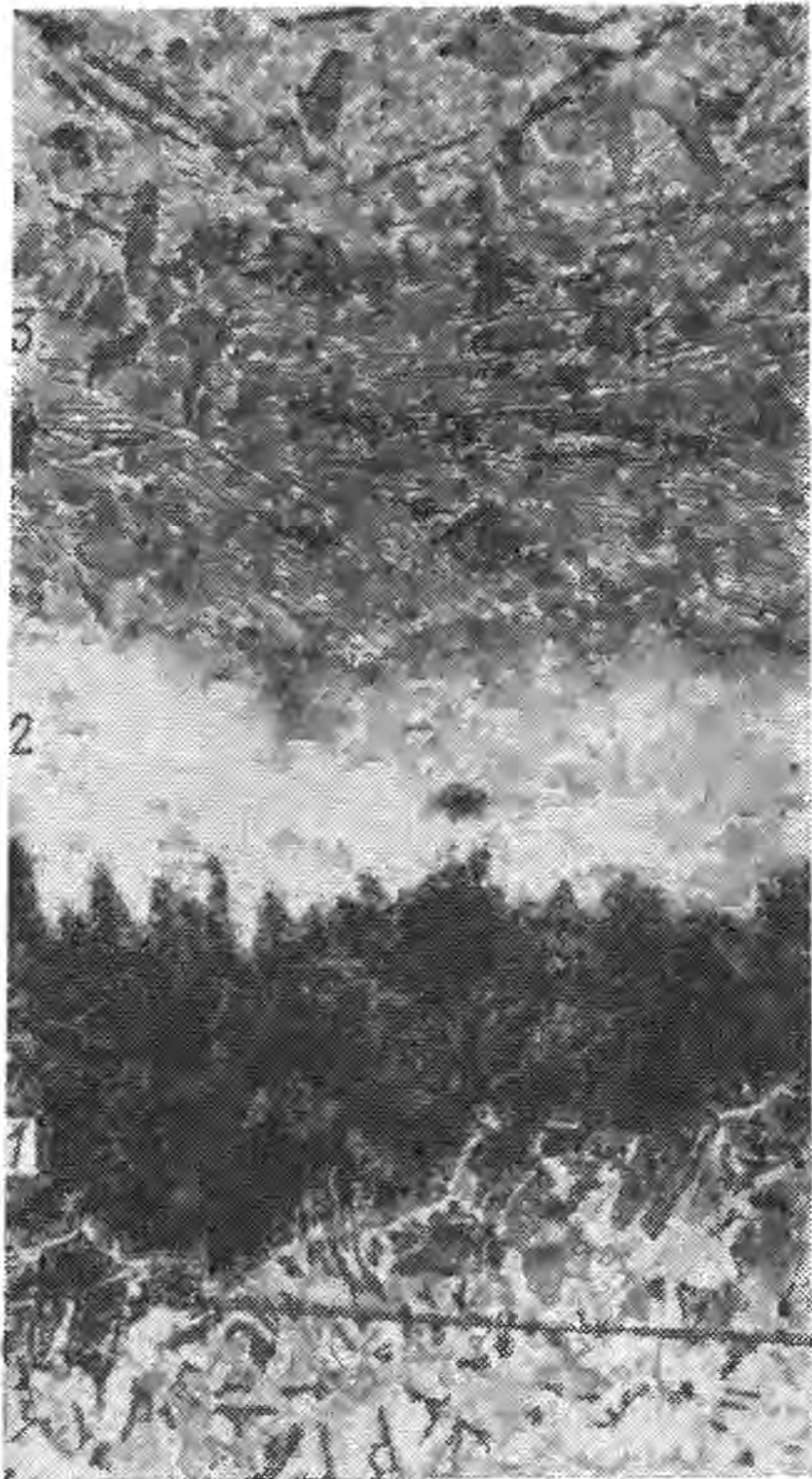
Рис. 142. Микроструктура зоны спая при пайке стали ВСт.3 припоем ВЗМИ49 в среде водорода. Температура пайки 1120^{\circ}\text{C} , выдержка 1,5 мин, \times 70 (косой срез)
