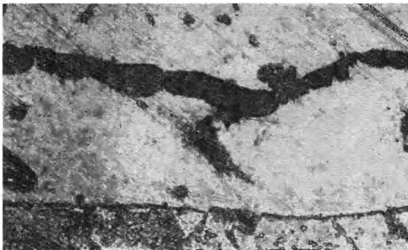
Рис. 43. Граница основной металл — зона сплавления при пайке предварительно окисленного железа Армоко медью в среде водорода, \times 600
