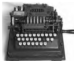
Рис. 10. Шифратор Schlüsselgerat SG-41 (Hitlermuhle).
