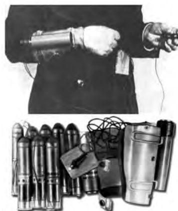
Рис. 7. Немецкий портативный гранатомёт «Панцеркнакке», выданный немецкому агенту для покушения на советских руководителей.
