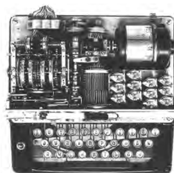
Рис. 8. Криптомашинa В-211 шведской фирмы «Aktiebolaget Cryptoteknik» с русифицированной клавиатурой
