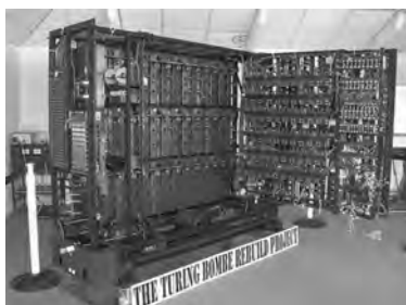
Рис. 18. Вид внутри машины Bombe (музейная реплика 2009 г.).
