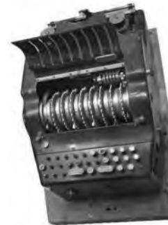
Рис. 5. Восемьроторная печатающая «Энигма» (1945г.)
