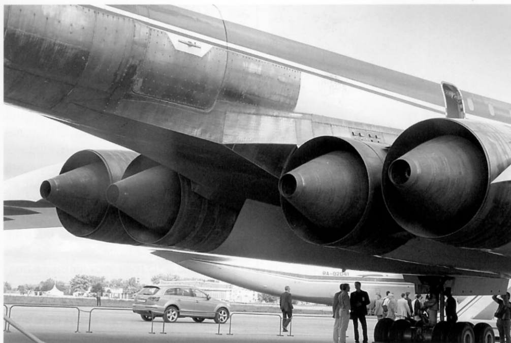
Сопла двигателей РД36-51А
