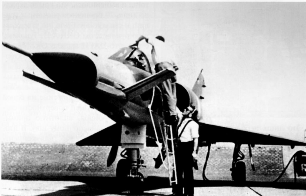
Переднее крыло («усы») было впервые исследовано на французском самолете-истребителе «Милан»
