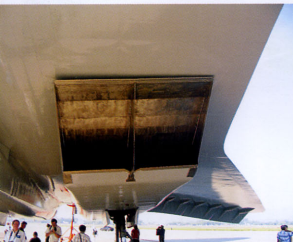
Входное устройство воздухозаборников двигателей РД36-51А
