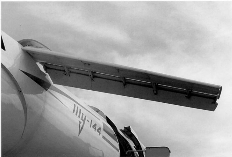
Переднее крыло самолета Ту-144Д
