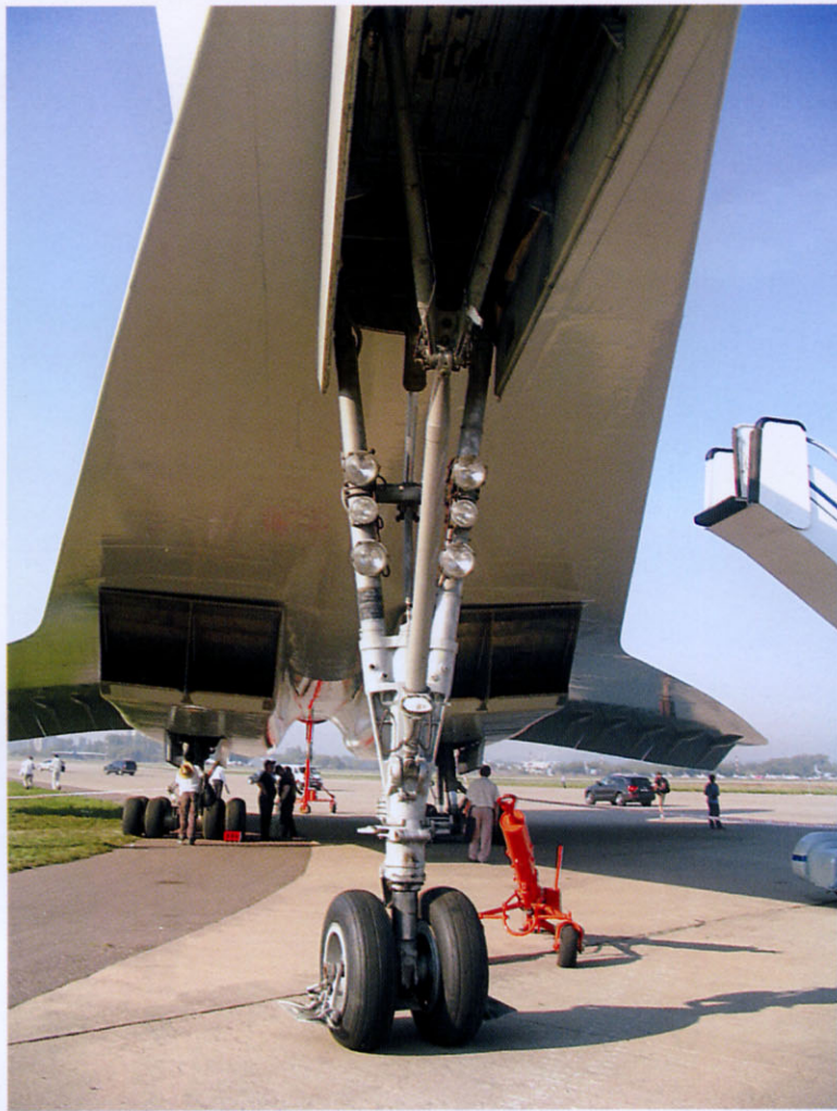
Передняя опора шасси Ту-144Д
