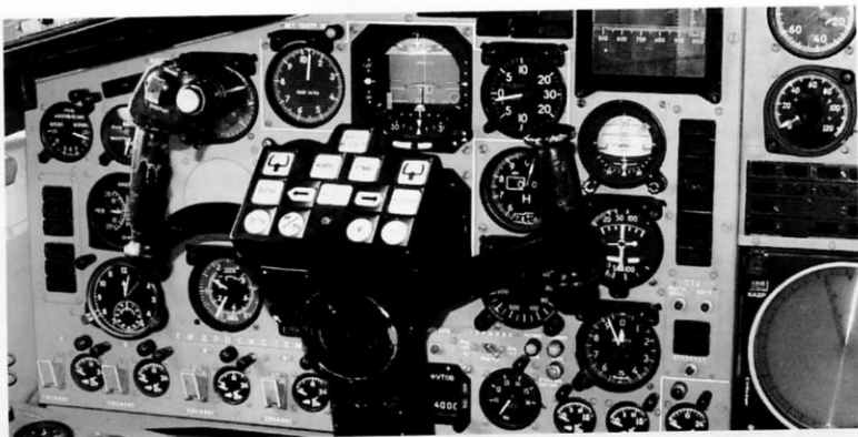
Пульт с клавиатурой поканального под- ключения траектор- ных вычислителей различных режимов полета
