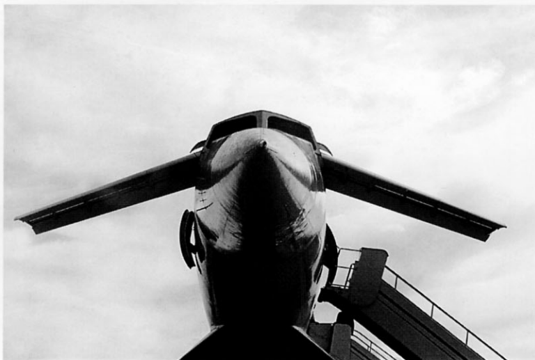
Переднее многощелевое крыло самолета Ту-144
