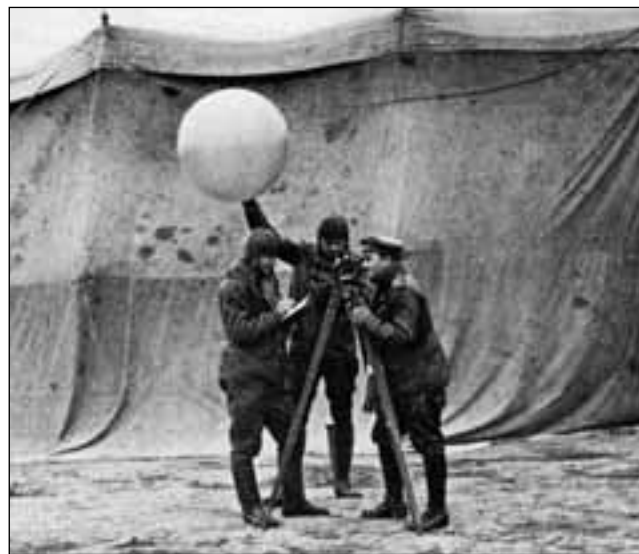
Запуск шара-зонда для определения скорости и направления ветра перед вылетом самолётов. 1915 г.
