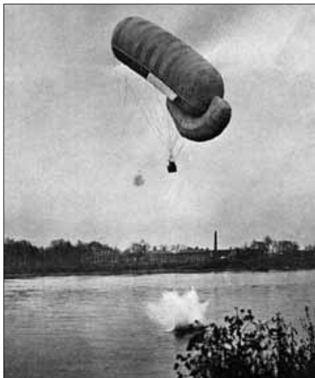
Сброс бомбы со змейкового аэростата, находящегося в свободном полете
