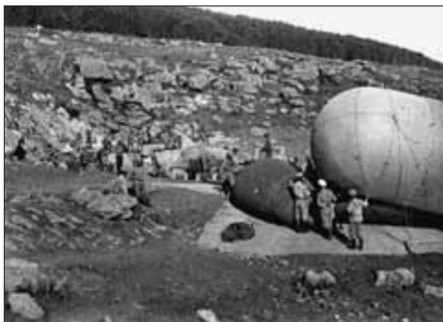
Наполнение змейкового аэростата объёмом в 750 м 3 водородом с помощью алюминиево-щёлочного газодобывательного аппарата (на фотографии он заслонён шарообразным газгольдером). 1913 г.
