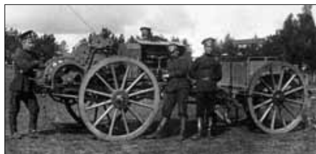
Конно-моторная лебёдка системы А.Е. Гарута образца 1908 г.
