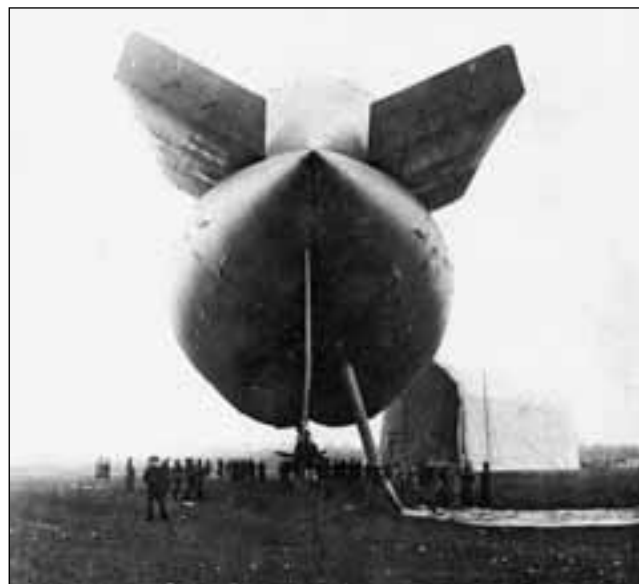
Вид на «Черномор» с кормы. Дирижабль подводят к переносному эллингу конструкции Уэйнимана
