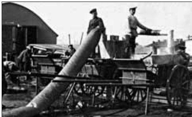
Получение водорода двукольным алюминиево-щёлочным газодобывательным аппаратом. В расположенной справа двуколке находится алюминиево- щёлочной газодобывательный аппарат, а в соединённой с ней коленчатой трубой двуколке — холодильники
