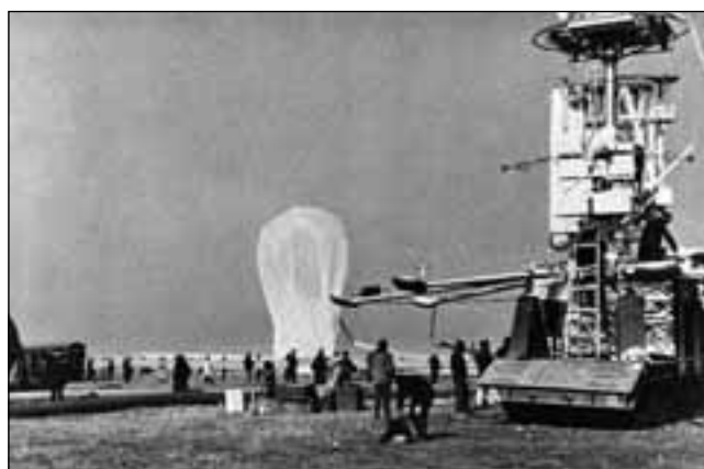
Наполнение оболочки аэростанции
