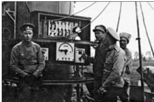
Н.Д. Анощенко у силиколевой газодобывательной установки фирмы «Оксилит» на конном ходу
