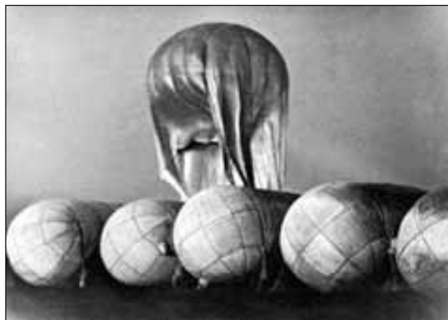
Наполнение стратостата «СССР-1» из газгольдеров
