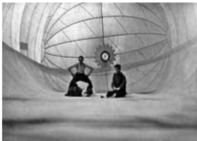
Внутри оболочки аэростата типа «Парсеваль»; проверка клапанной верёвки
