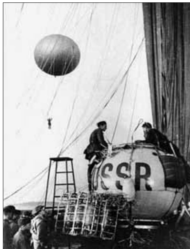
Подготовка к полету «СССР-1 бис». К гондоле подвешены приборы для изучения космической радиации (внизу слева) и парашют (справа)
