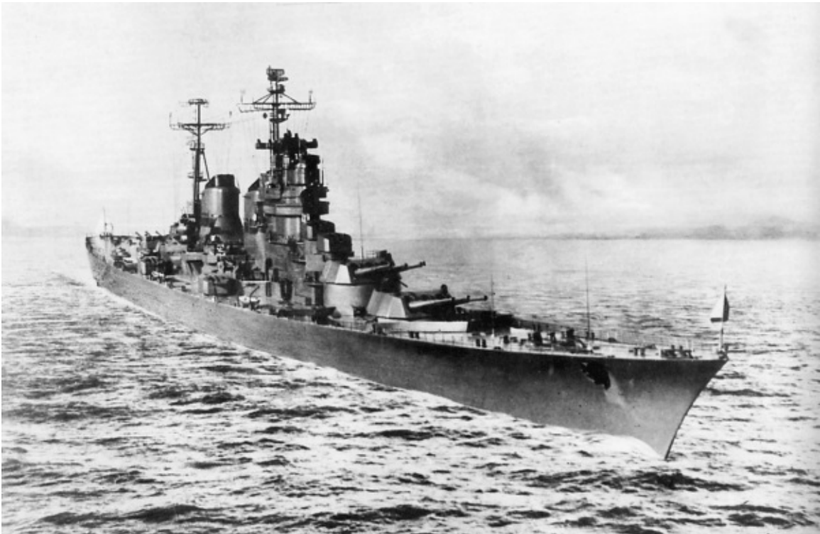
Так должен был выглядеть тяжелый крейсер проекта 82, вооруженный 305-мм пушками. Из коллекции С. Е. Виноградова
