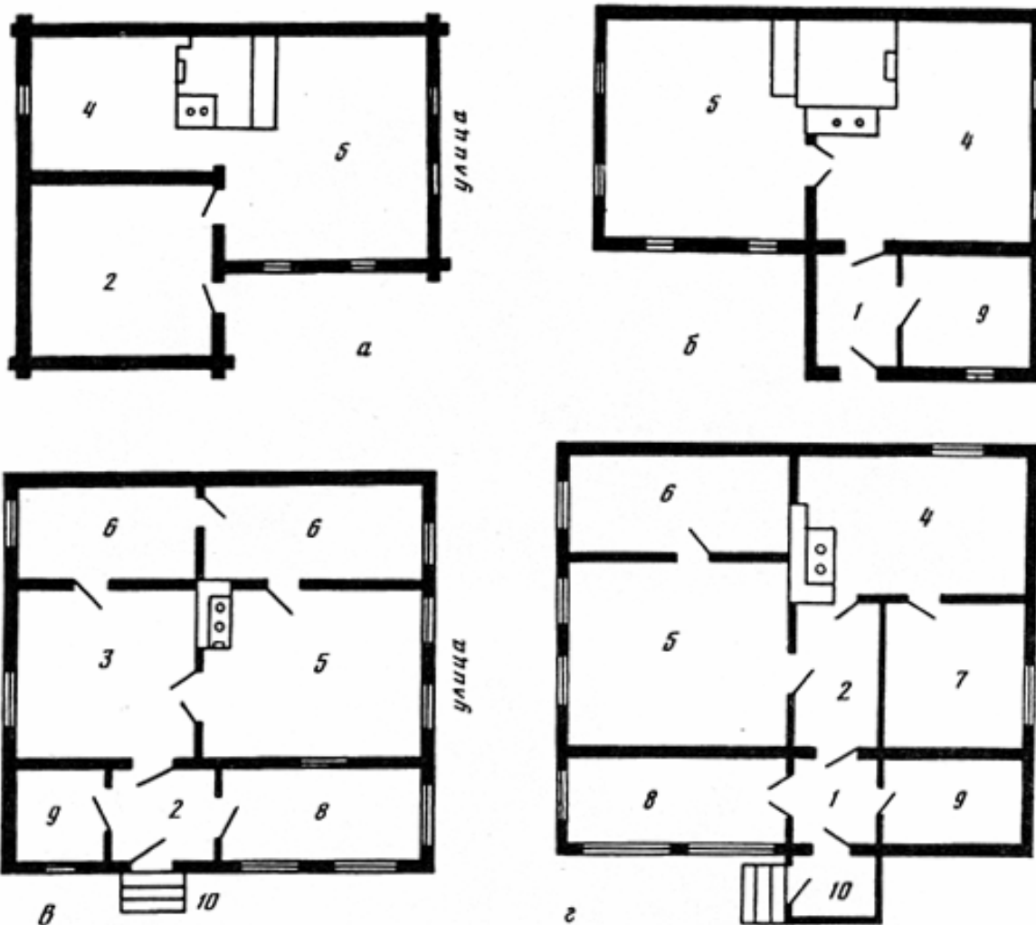
Планировки многоквартирных домов 1960–1970-х годов, Курская и Белгородская области (а, б, в, г): 1 – коридор, 2 – сени, 3 – прихожая, 4 – кухня, 5 – зал, 6 – спальня, 7 – детская, 8 – веранда, 9 – кладовка, 10 – крыльцо
