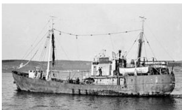
СТР-300: четыре траулера этого типа - «Боскитогорск», «Севск», «Севан» и «Нахичевань» затонули от обледенения 16 января 1965 г. Погибло более 100 рыбаков.
