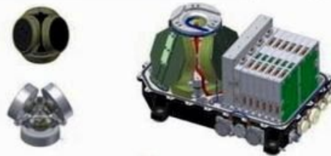
Бесплатформенный инерциальный блок на основе волоконно-оптических гироскопов и маятниковых акселерометров (БИБ-ВОГ)
