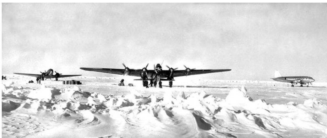
На ледовом аэродроме (слева направо): военно-транспортный самолёт Ли-2, «бензовоз» Пе-8 и пассажирский Ил-12
