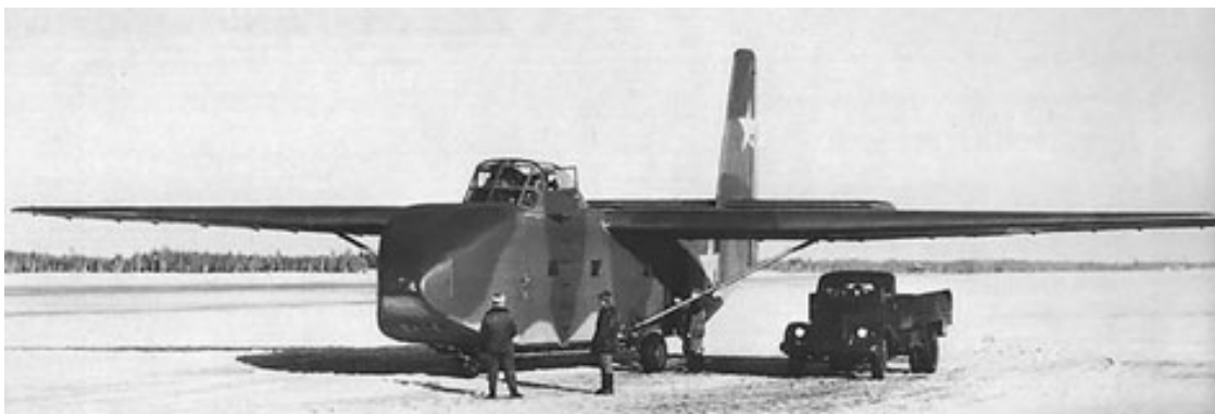
Як-14 – десантно-грузовой планер для переброски по воздуху крупногабаритных грузов весом до 3,5 тонн. Построено 408 планеров этого типа
