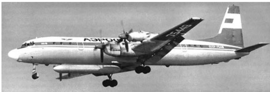
Самолёт Ил-24Н с контейнером радиоэлектронного комплекса «Нить-К» под фюзеляжем.
