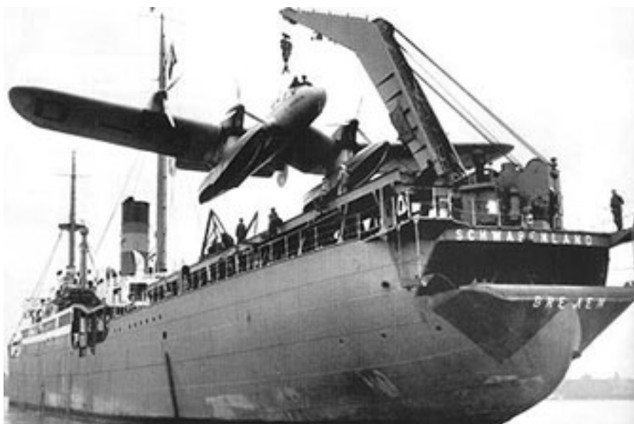
Установка на катапульту германского судна «Швабеланд» гидросамолёта «Blohm und Voss» Ha.139
