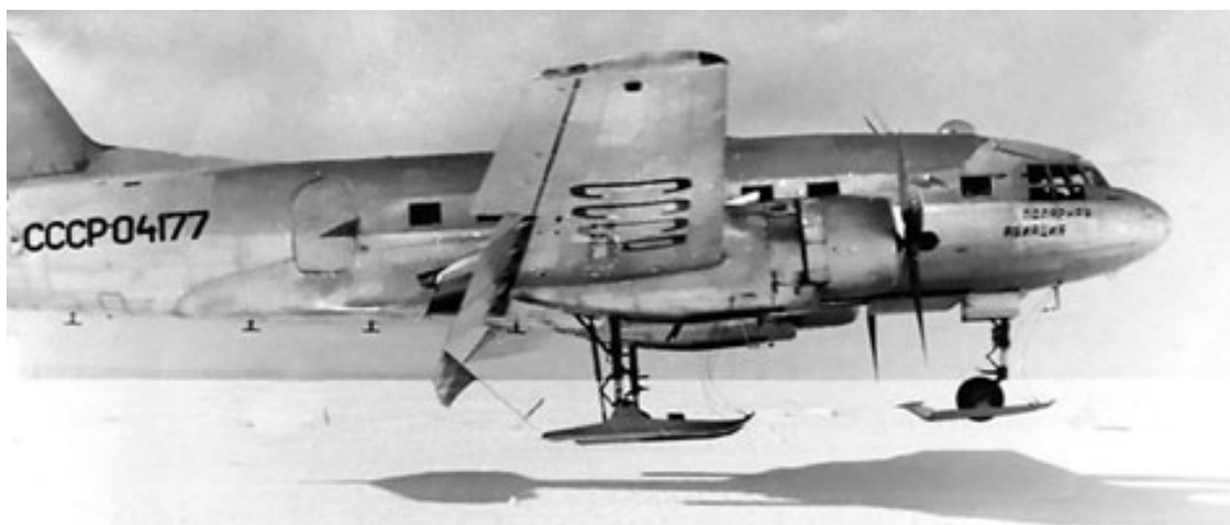
Ледовый разведчик Ил-14ЛР. Под фюзеляжем виден обтекатель РЛС.
