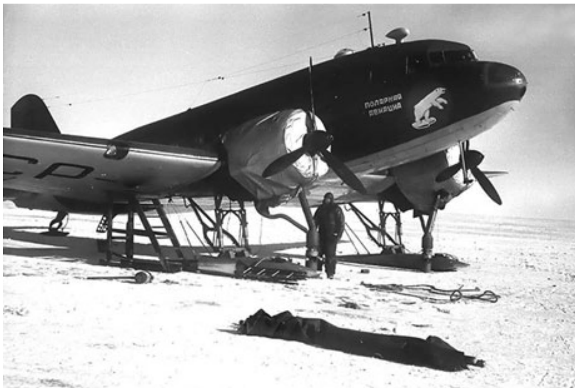
Прогрев двигателя полярного Ли-2 перед запуском специальной печкой.
