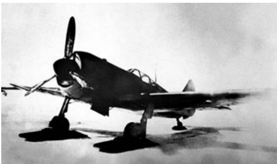
Истребитель Ла-11 на лыжах. Лыжи имели сверху специальное гнездо для свободного захода самолёта на колёсах, фиксировавшихся упорами с полукруглыми вырезами.
