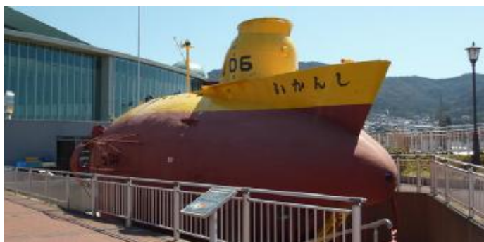
«HU 06 Shikai (Глубокое море)» - первый глубоководный аппарат Японии, созданный 1968 г. Глубина погружения – до 600 м. Экспонируется в г. Куре.
