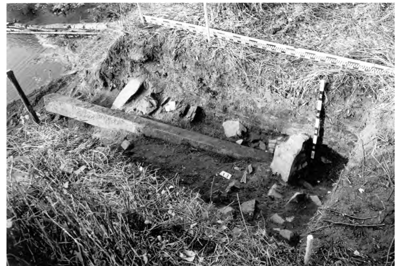
Рис. 27. Чугунный брус, выломанный из свода над меховой фурмой доменной печи Азяш-Уфимского завода.
