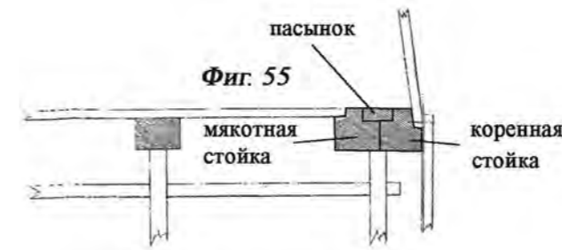
Рис. 55. Способ соединения коренной и мякотной стоек при помощи пасынка (по В. Рожкову).
