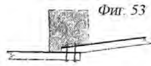
Рис. 58. Крепление обшивки прорезов (по В. Рожкову).
