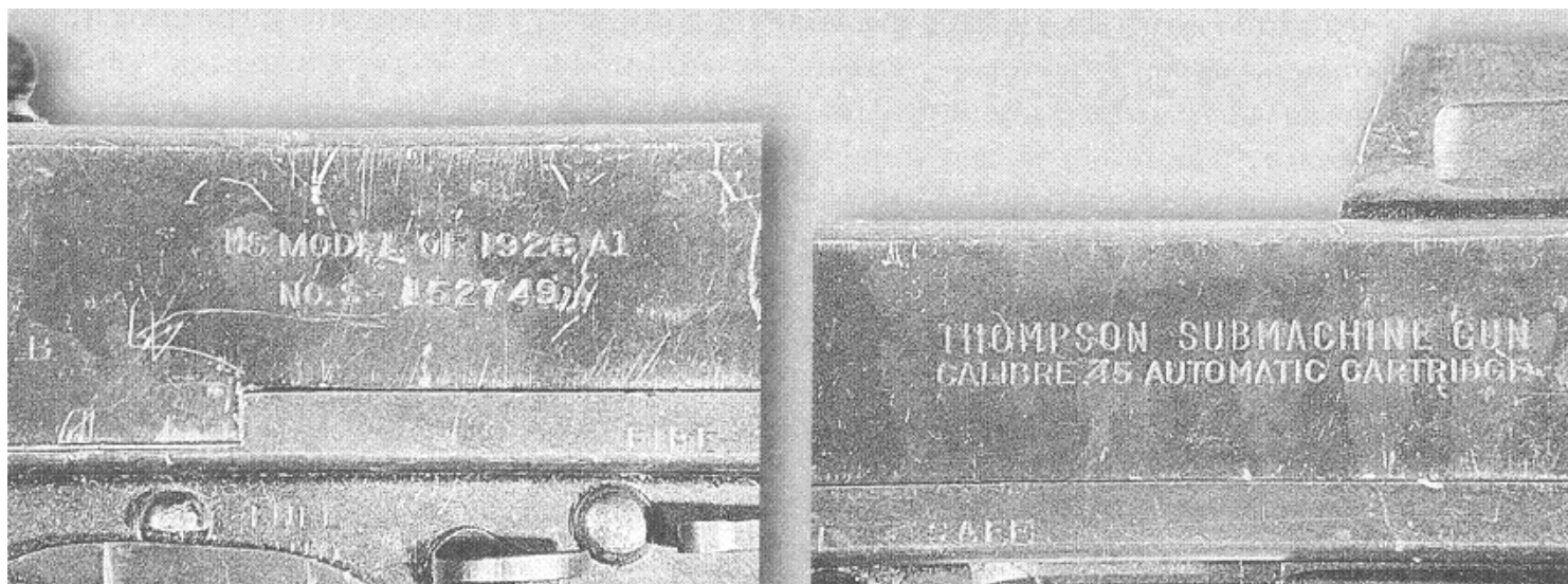
Клейма на затворной коробке пистолета-пулемета М1928А1.
