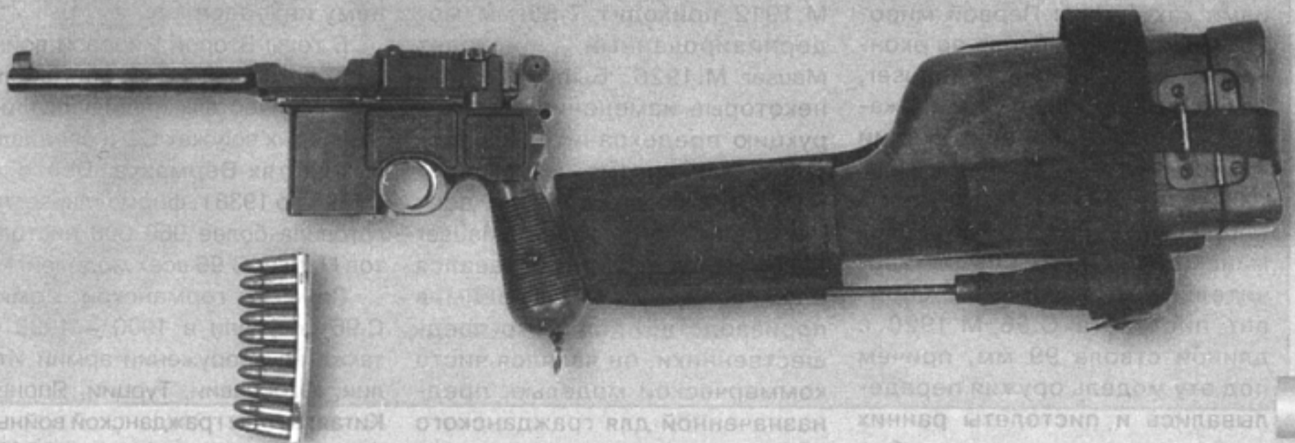
Все модели пистолетов Mauser C.96 комплектовались приставной кобурой-прикладом. При заряджании патроны помещались в неотъемный магазин при помощи обоймы. На снимке пистолет Mauser K.96, кобура-приклад в походном варианте, обойма с патронами.
