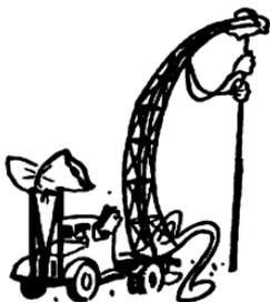
Теперь бурильщики выверяют соосность — направленность мачты и ротора. Ротор, вращательный механизм, расположенный над скважиной, — важнейшая часть буровой установки. Он состоит из литого корпуса, стола с коническим зубчатым венцом и конической шестерни — хвостовика. Стол имеет квадратное отверстие, через которое вращение передается на рабочую трубу бурильной колонны, тоже квадратную.
