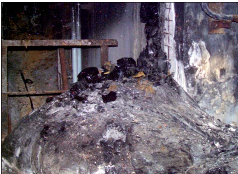
Рис. 1. «Слоновья нога»: «лава», застывшая в такой необычной форме в помещении 217/2
