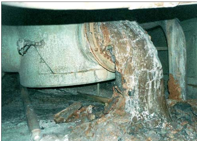
Рис. 26. Поток застывшей лавы в клапане
