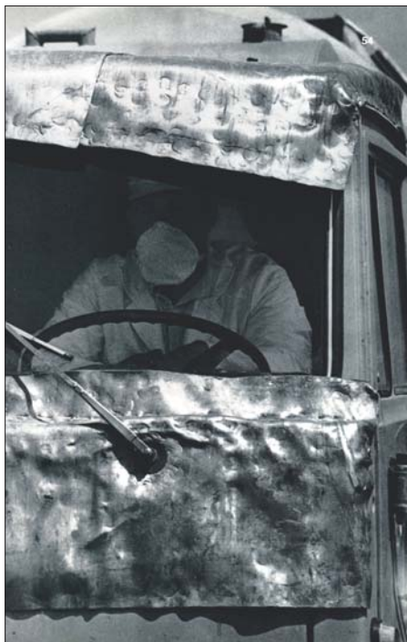
Рис. 6. Для защиты водителей грузовых машин, вывозящих радиоактивный грунт, кабины машин защищались свинцовыми листами
