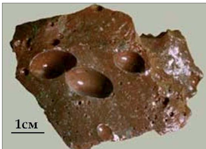
Рис. 6. Коричневая лава из парораспределительного коридора
