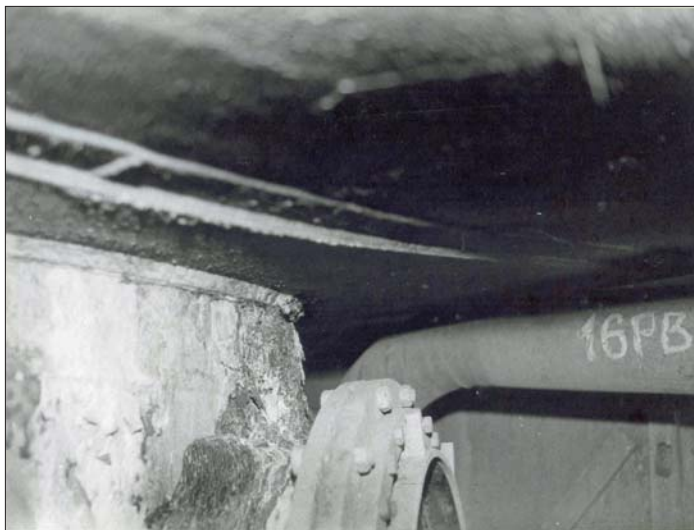
Рис. 23. Проплавление лавой металла клапана ПРК
