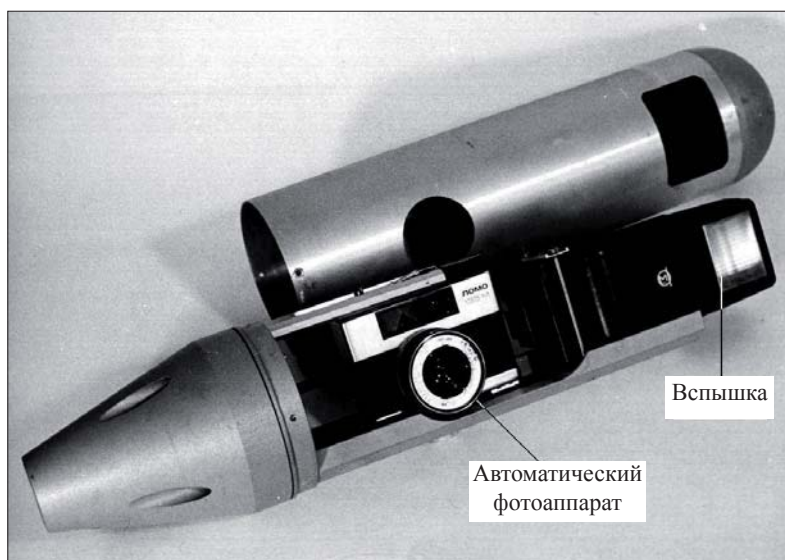
Рис. 12. «Фото-зонд», разработанный для съемок через скважины. Позволял проводить панорамное фотографирование
