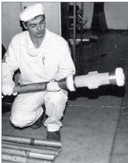
Рис. 7. Подготовка к работе теплотрического зонда для измерений в скважинах
