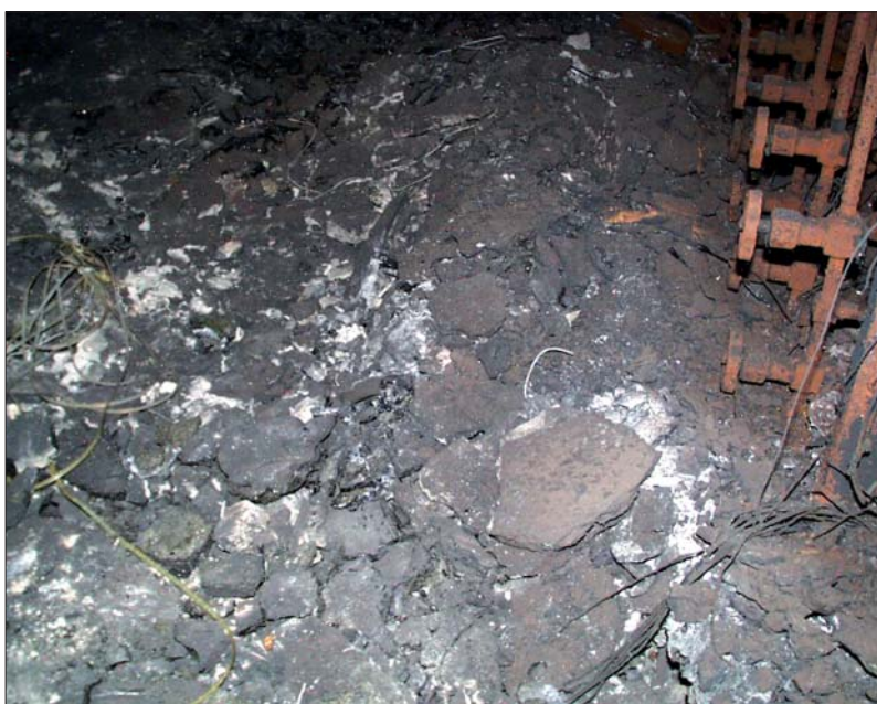
Рис. 23. Черная керамика на полу пом. 304/3. В это помещение лава проникла через пролом в стене из пом. 305/2. Здесь – начало «горизонтального потока»
