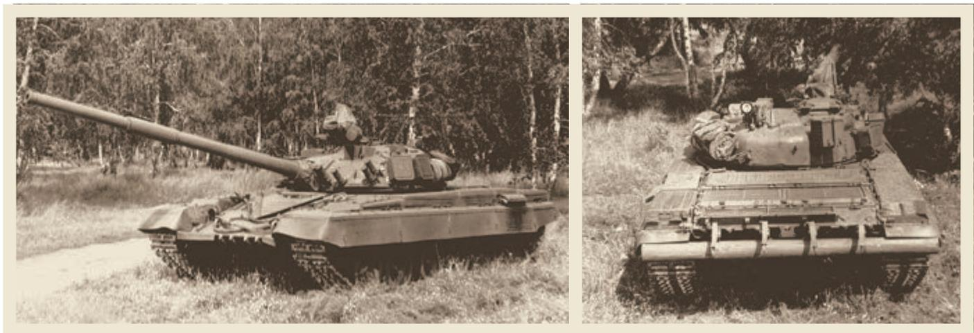
ДИЗЕЛЬНЫЙ ВАРИАНТ ТАНКА Т-80Б – «ОБЪЕКТ 644».
