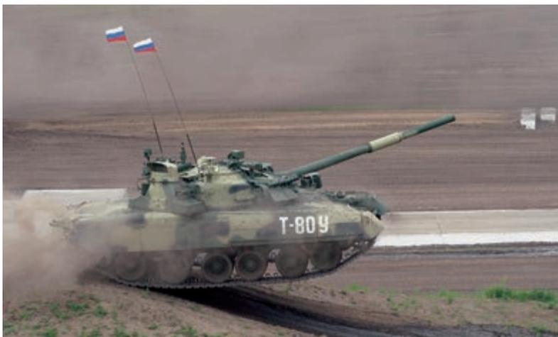
ТАНК Т-80У С УСТАНОВЛЕННЫМ КОМПЛЕКСОМ АКТИВНОЙ ЗАЩИТЫ «АРЕНА».
