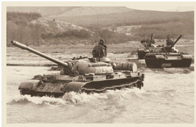
И в том же 1966 году начался выпуск отработанной в 1962–1964 годах гусеницы с резино-металлическим шарниром для танков Т-54, Т-55 и Т-62, способной проходить 5–6 тысяч километров («изделие ВР.613»). Это в три раза превышало показатели прежней гусеницы с открытым металлическим шарниром [36].
