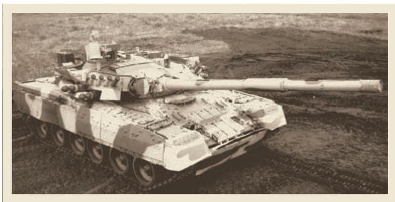
ТАНК Т-80У С УСТАНОВЛЕННЫМ КОМПЛЕКСОМ АКТИВНОЙ ЗАЩИТЫ «ДРОЗД».
