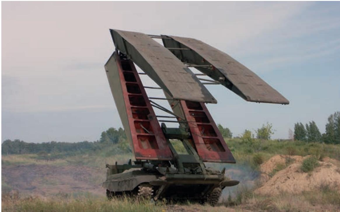
МОДЕРНИЗИРОВАННЫЙ МОСТУКЛАДЧИК МТУ-90М.
