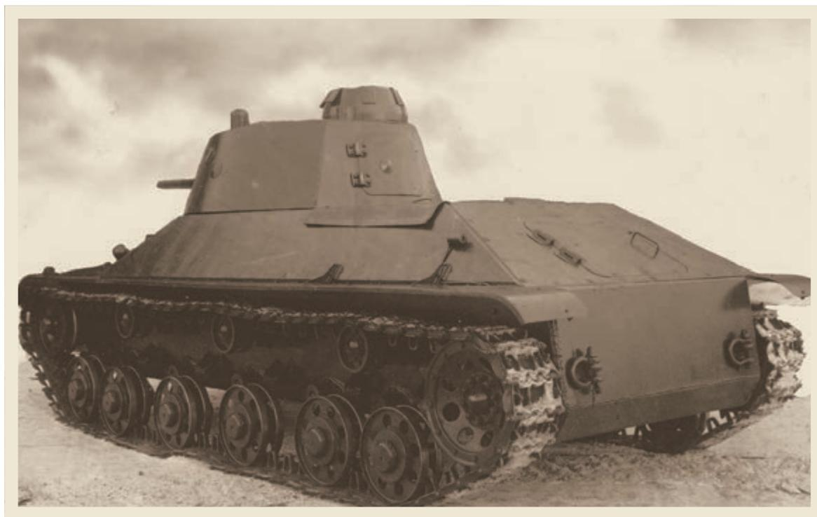
Весной 1940 года на «объект 111» вместо карбюраторного двигателя был установлен дизель В-2 и электромеханические сервоприводы управления трансмиссией. В таком виде машина должна была отправиться на Карельский перешеек для участия в боевых действиях с Финляндией, но на фронт опоздала — война закончилась раньше [63].
