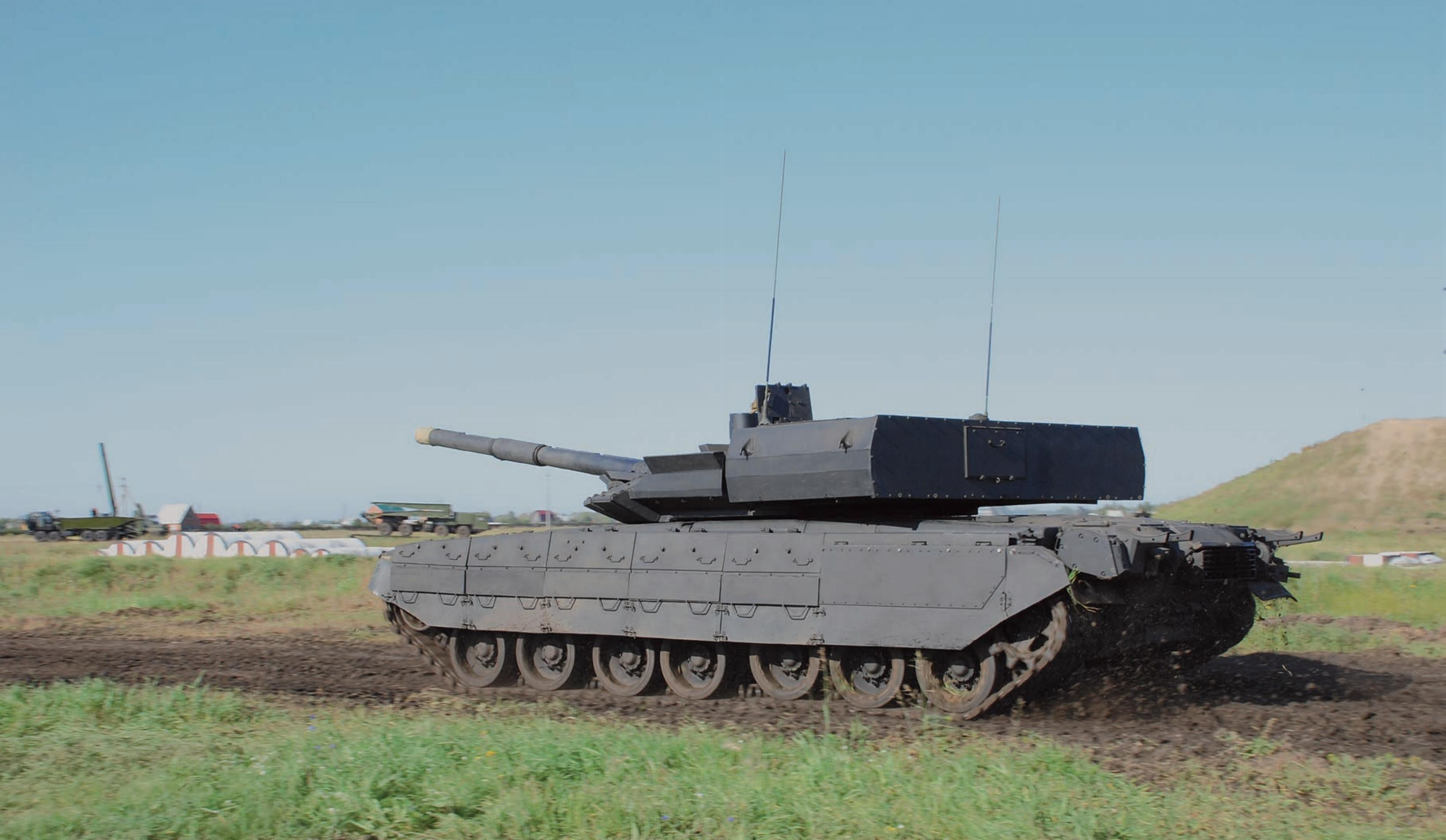
МОДЕРНИЗИРОВАННЫЙ ТАНК Т-55 С 6-КАТКОВОЙ ХОДОВОЙ ЧАСТЬЮ И 125-ММ ОРУДИЕМ С АВТОМАТОМ ЗАРЯЖАНИЯ.
