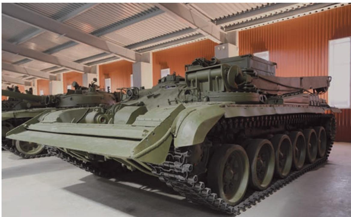
БРЕНИРОВАННАЯ РЕМОТНО-ЭВАКУАЦИОННАЯ МАШИНА БРЭМ-1 НА БАЗЕ ТАНКА Т-72 В ЭКСПОЗИЦИИ МУЗЕЯ БРОНЕТАНКОВОЙ ТЕХНИКИ УРАЛВАГОНЗАВОДА.
