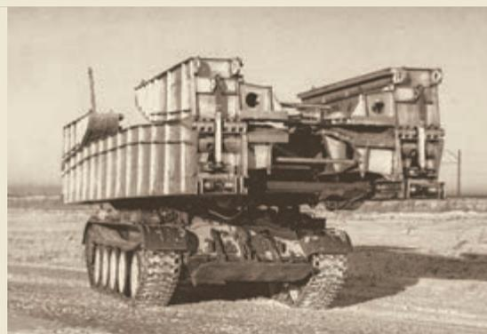
В 1960–1963 годах был создан и в 1964 году принят на вооружение мостоукладчик МТУ-20. Он предназначался для продвижения войск через препятствия шириной до 18 метров, в том числе в боевых условиях. Серийное производство мостоукладчиков началось на заводе имени Октябрьской революции в 1966 году; всего было изготовлено 1222 машины [41].
