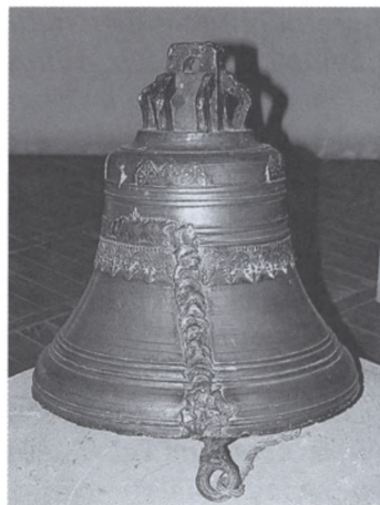
Отремонтированный сваркой колокол
