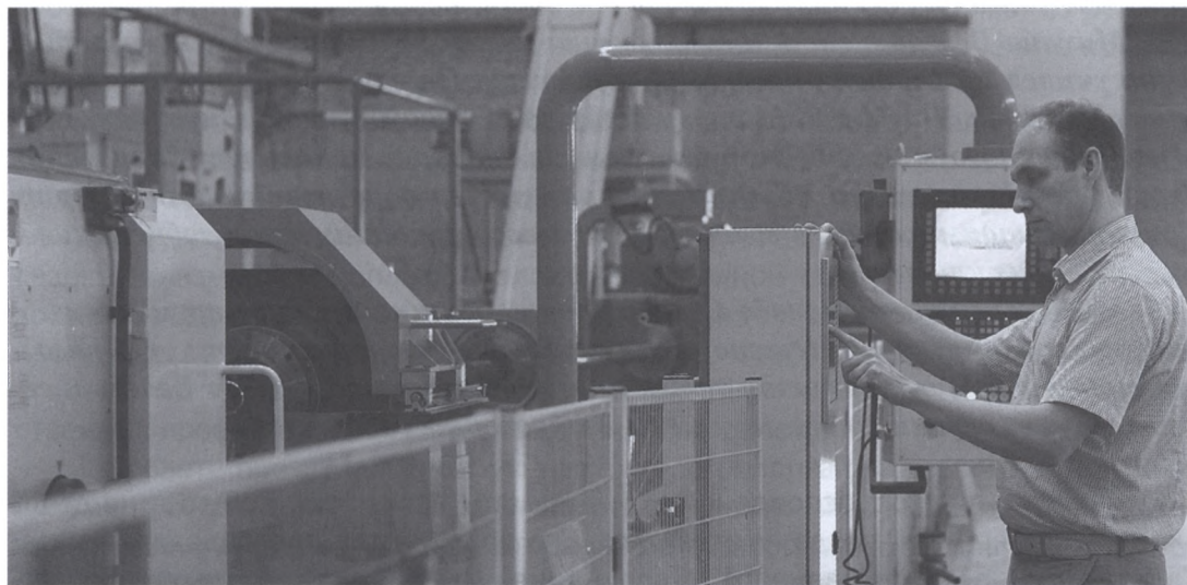
Михаил Ведель апробирует изобретённую им установку на станке глубокого сверления в цехе завода
