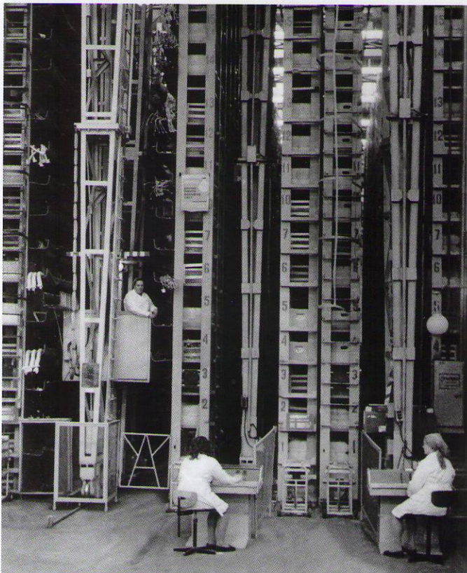
Высокомеханизированные стеллажи заводского склада
