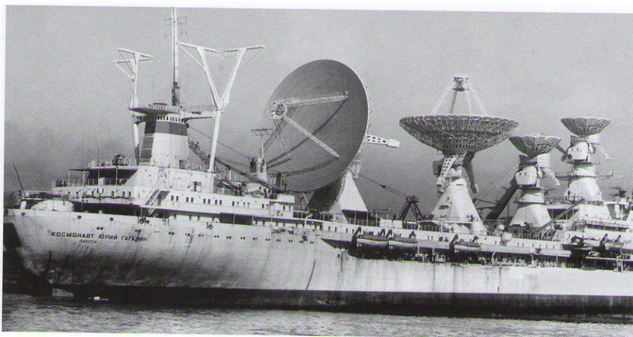
Антенны для космической связи на научно-исследовательских судах изготавливались на АО «НАЗ «Сокол»
