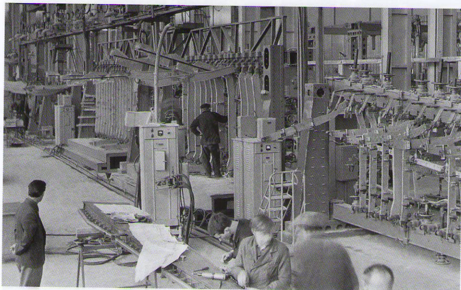
Механизированная линия сборки и сварки панелей крыла
