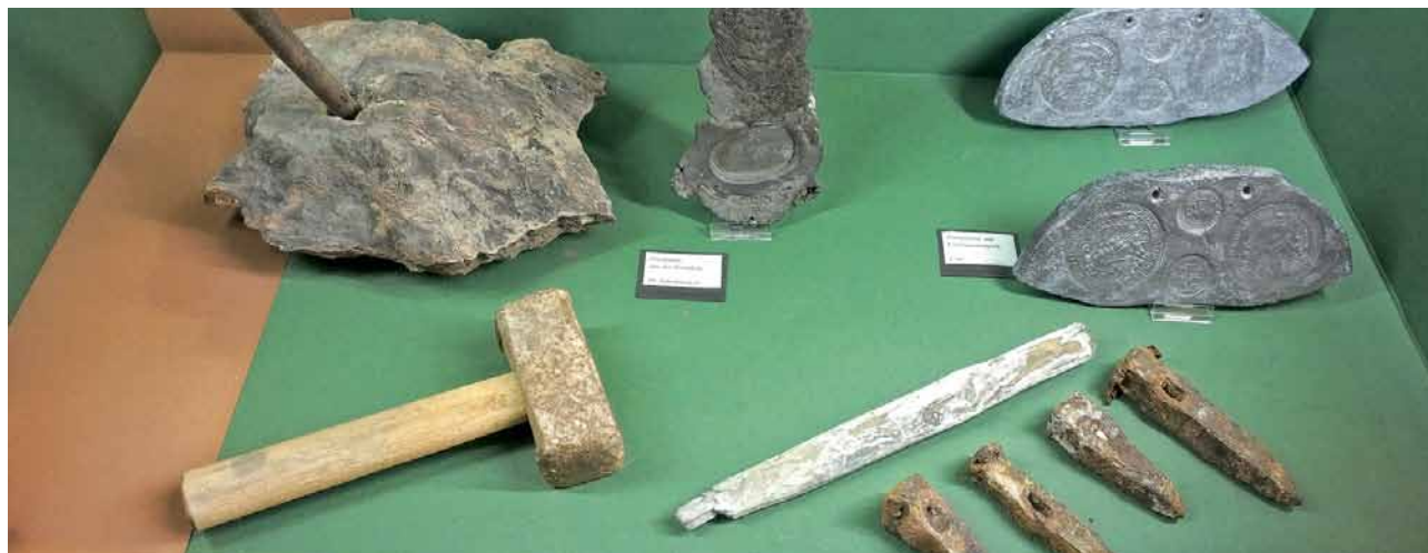
Горняцкие инструменты для обработки твердой руды. Шахта Эренсдорф, Саксония
