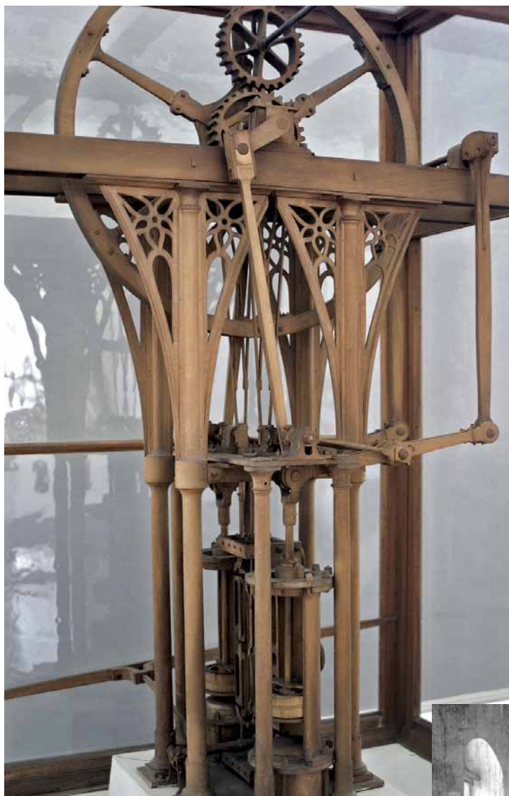
Сдвоенная вертикальная паровая машина. Экспонат Музея Фрайбергской академии, мастер Ф.А. Клопфер, Фрайберг, Германия, 1837 г.
