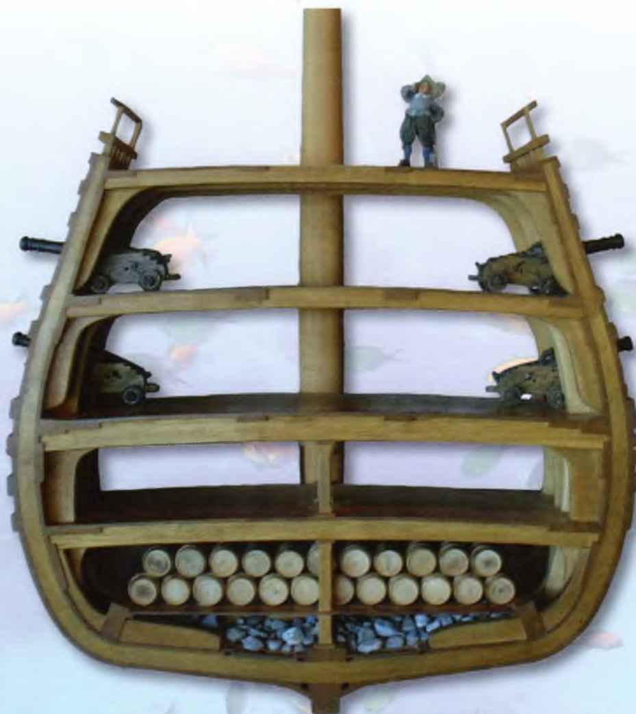
Модель разреза корпуса «Вазы»: типичное для классических парусников однообразное артиллерийское вооружение
