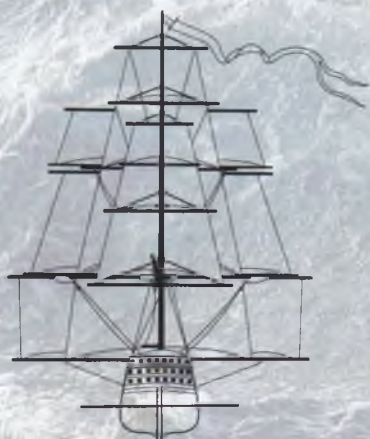
Система парусного вооружения с вынесенными реями последних серий русских парусных кораблей Черноморского флота
