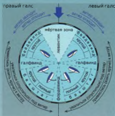
Курсы парусного корабля относительно ветра (дугообразные линии — положение парусов)
