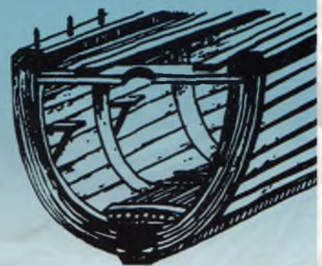
Корабль греков героической эпохи: разрез корпуса
