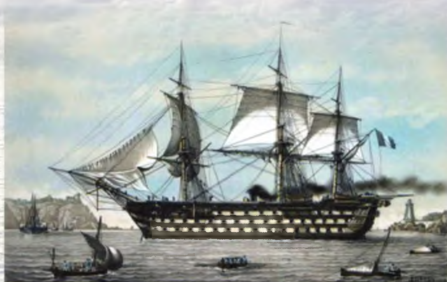
Французский парусно-винтовой корабль «Людовик XIV» 1828 г., модернизированный под паровую машину в 1857 г.
