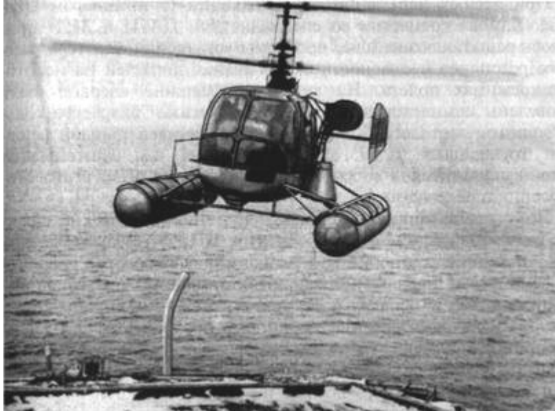
Рис. 295. Поплавковый вариант Ка-15Г при посадке на палубу корабля
