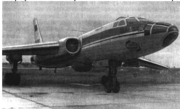
Рис. 187. Самолет для гидрометеорологических исследований Ту-16 "Циклон"
