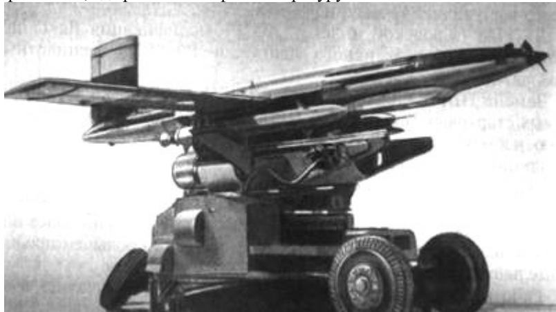
Рис. 86. Беспилотный самолет-фоторазведчик Ла-17Р ("204") на пусковом устройстве
