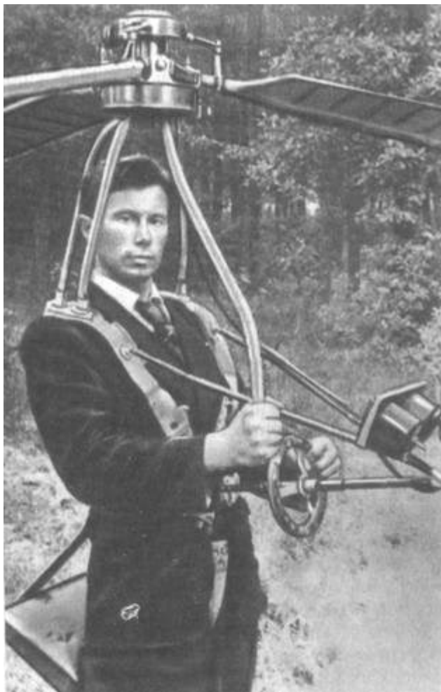
Рис. 336. Ф.П. Курочкин с автожиром собственной конструкции Испытывали автожир, буксируя грузовиком ГАЗ-АА на тросе длиной 25 м.
