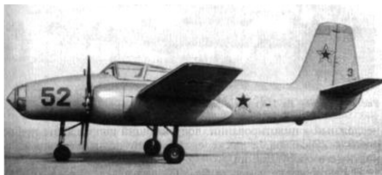
Рис. 236. Самолет Як-200, первоначальный вид Требовался простой по конструкции и эксплуатации самолет, несложный в пилотировании, допускающий исправление грубых ошибок курсантов, а также снабженный полным комплектом новейшего оборудования.
