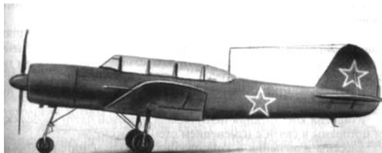
Рис. 227. Самолет Як-18 с экспериментальным неубирающимся трехколесным шасси
