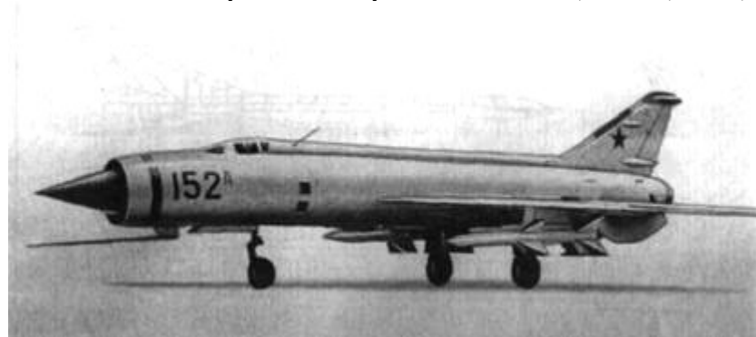
Рис. 131. Истребитель-перехватчик Е-152А с двумя ракетами К-9
