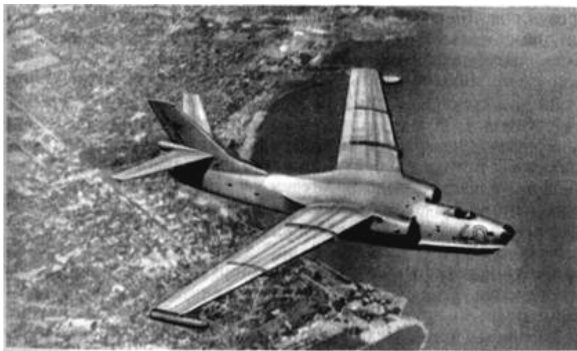
Рис. 47. Реактивный гидросамолет Бе-10 Морской разведчик-торпедоносец Бе-10 (рис. 47) - цельнометаллическая летающая лодка с двумя турбореактивными двигателями АЛ-7ПБ, высокорасположенным стреловидным крылом, стреловидным горизонтальным и вертикальным оперениями и установленными на концах консолей крыла подкрыльными поплавками боковой остойчивости. Экипаж - три человека: летчик, штурман и стрелок-радист. Крыло - свободное, монопланное по схеме "чайка", с отрицательным поперечным V, двухлонжеронное, кессонного типа, снабжено выдвижными одноцелевыми закрылками, отклоняемыми гидроприводной трансмиссионной системой с шариковинтовыми подъемниками.
