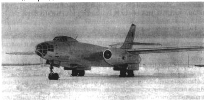
Рис. 51. Опытный бомбардировщик Ил-46 с прямым крылом
