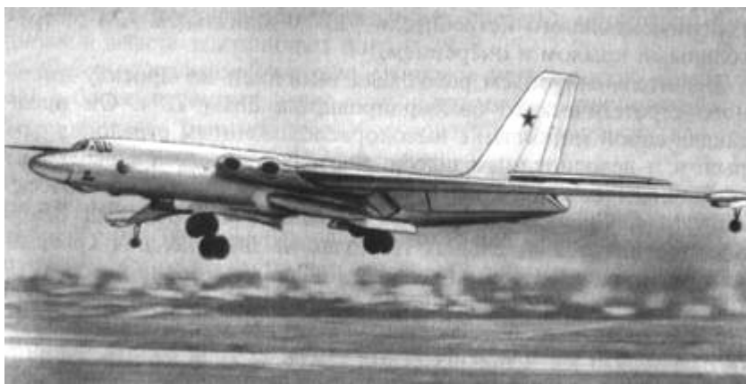
Рис. 144. Дальний бомбардировщик ЗМ, оборудованный подвесными топливными баками
