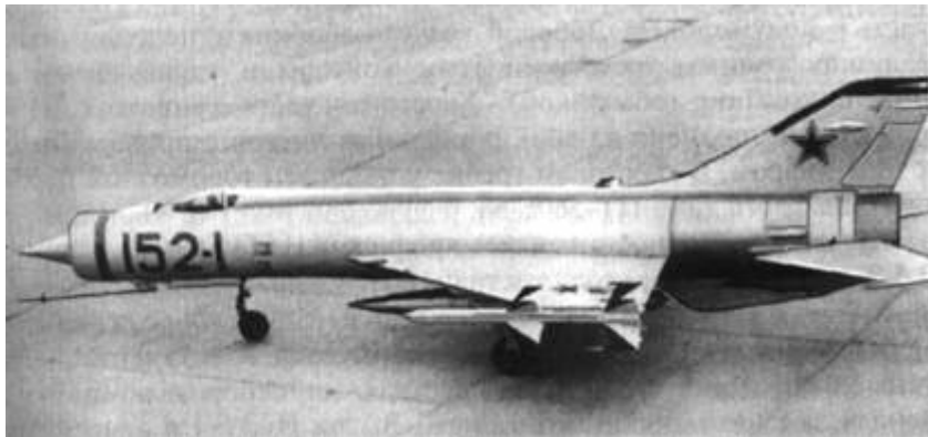
Рис. 132. Истребитель-перехватчик Е-152/1 с двумя ракетами К-9
