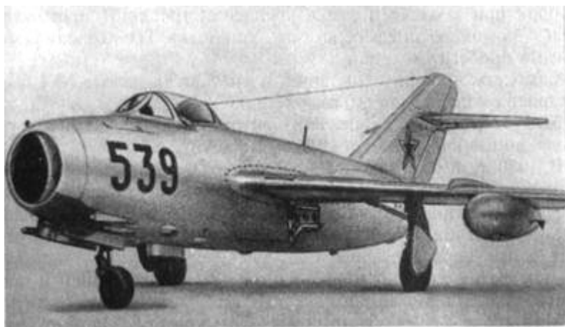
Рис. 89. Самолет МиГ-15бис, оборудованный заградительной системой "Град"
