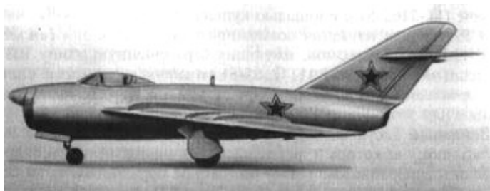
Рис. 90. Истребитель-перехватчик СП-2 с РЛС "Коршун"
