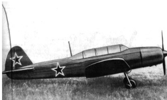
Рис. 226. Самолет Як-18 с двигателем М-12 Рис. 225.
