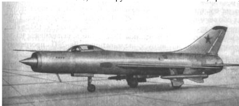
Рис. 172. Опытный истребитель-перехватчик Т-47 (прототип серийного Су-11)
