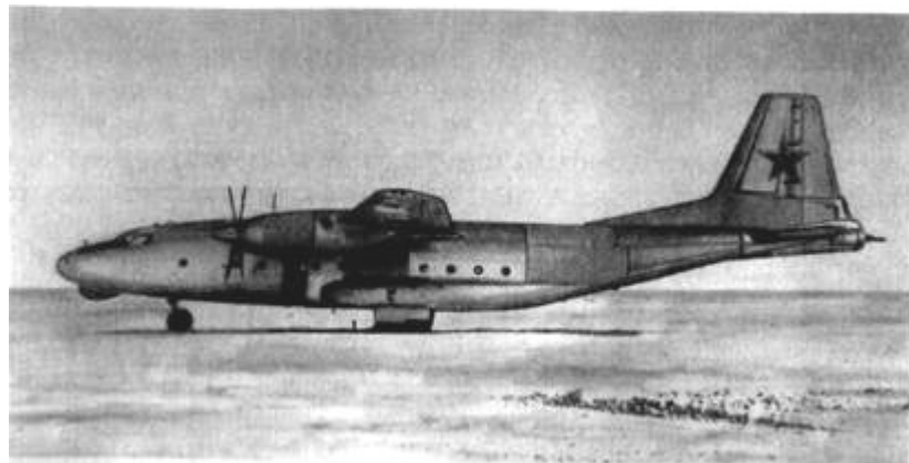
Рис. 22. Военно-транспортный самолет Ан-8 с двигателями ТВ-2Т
