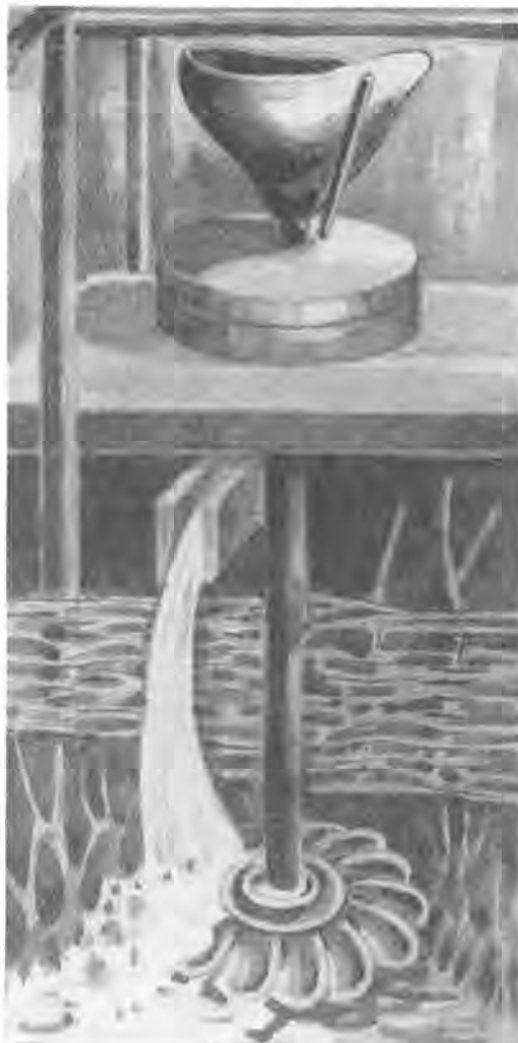
5. Водяной двигатель, получивший широкое распространение в России в XVI в.
