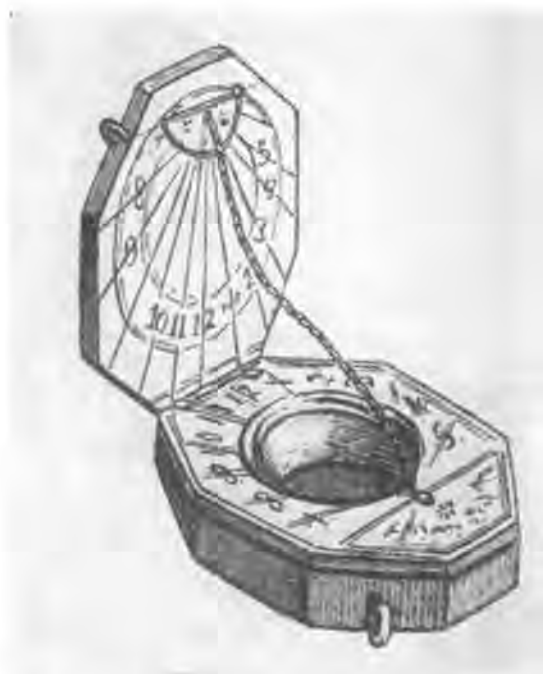
230. Русский навигационный прибор начала XVII в. Солнечные часы-компас.
