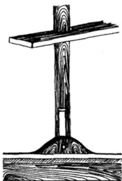
Степс древнегреческой мачты, вид сбоку. Реконструкция
