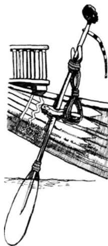
Рулевое весло и его крепление
