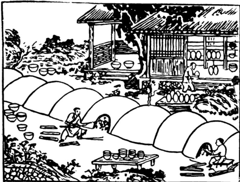
Рис. 26. Секционные печи для обжига керамики.
