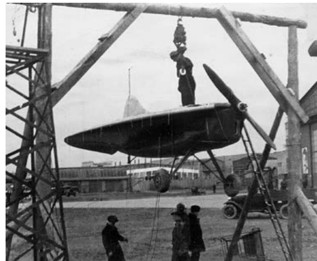
Исследование обтекания «Стрелы» на наземном стенде. Апрель 1938 г.
