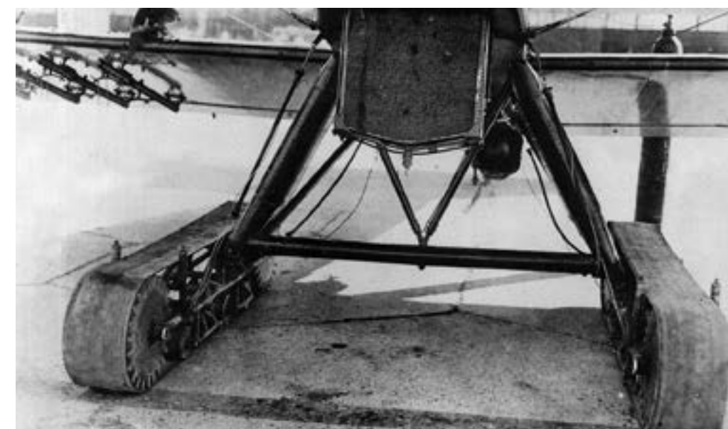
Первый вариант гусеничного шасси для самолёта Р-5, 1936 г.
