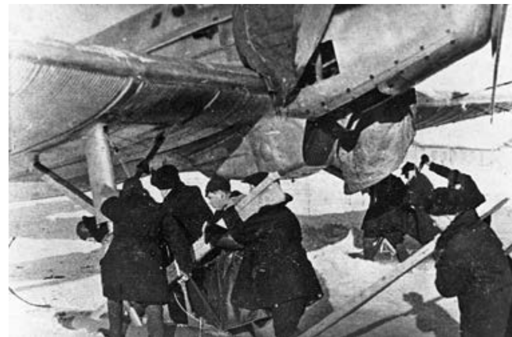
Установка БОК-1 на лыжное шасси
