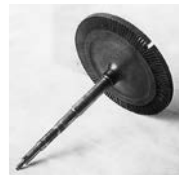
Турбина компрессора с оборванной лопаткой
