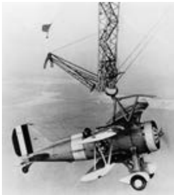
Истребитель Кертисс F9C-2 на причальной трапедии дирижабля «Мэйкон», 1933 г.
