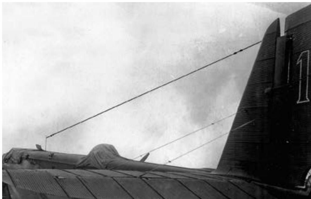
Приёмная антенна самолёта ТБ-3 «Бомба»
