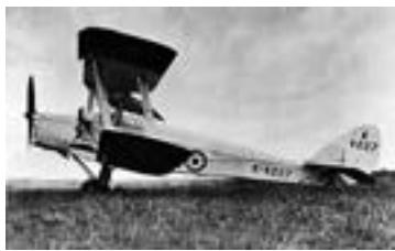
Первый в мире беспилотник DH.82B (Англия, 1935 г.), способный самостоятельно возвращаться к месту старта. Использовался флотом и ВВС Великобритании до 1947 г.
