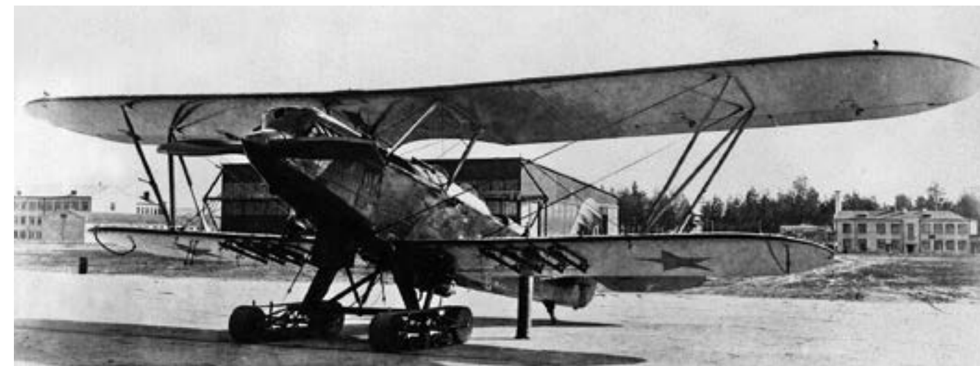
Первый вариант гусеничного шасси для самолёта Р-5, 1936 г.
