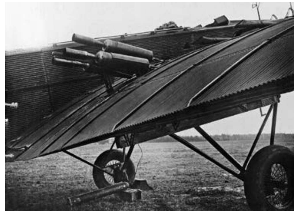
Новая компоновка ускорителей на ТБ-1. 1933 г.
