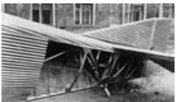
Конструкция хвостовой части самолёта
