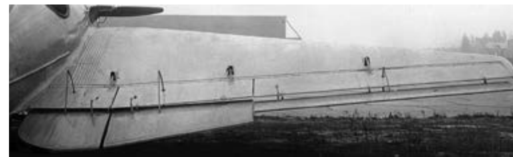
Поворотная часть крыла и рулевые поверхности
