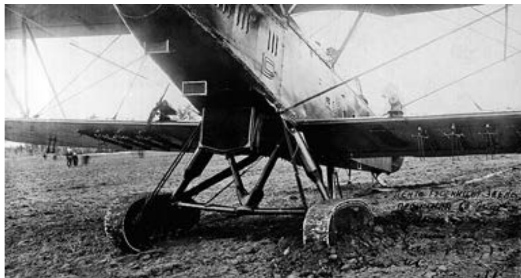
Испытания Р-5 с усовершенствованным гусеничным шасси, 1938 г.
