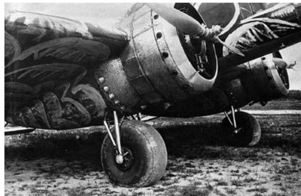
Большие неубирающиеся колеса сильно портили аэродинамику самолёта
