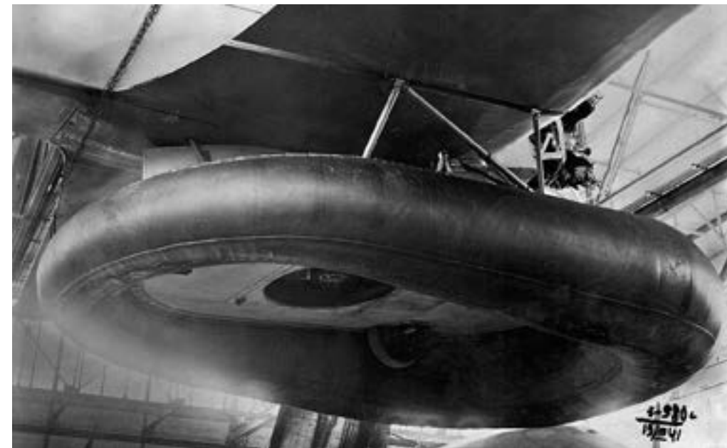
Конструкция воздушной подушки самолёта УТ-2Н
