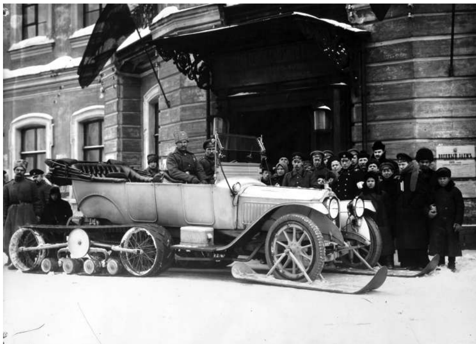
Царский автомобиль на лыжах у мастерской Ипата. «Руссо-Балт» Д24-40 7-й серии на полугусеничном ходу. 1913 г.
